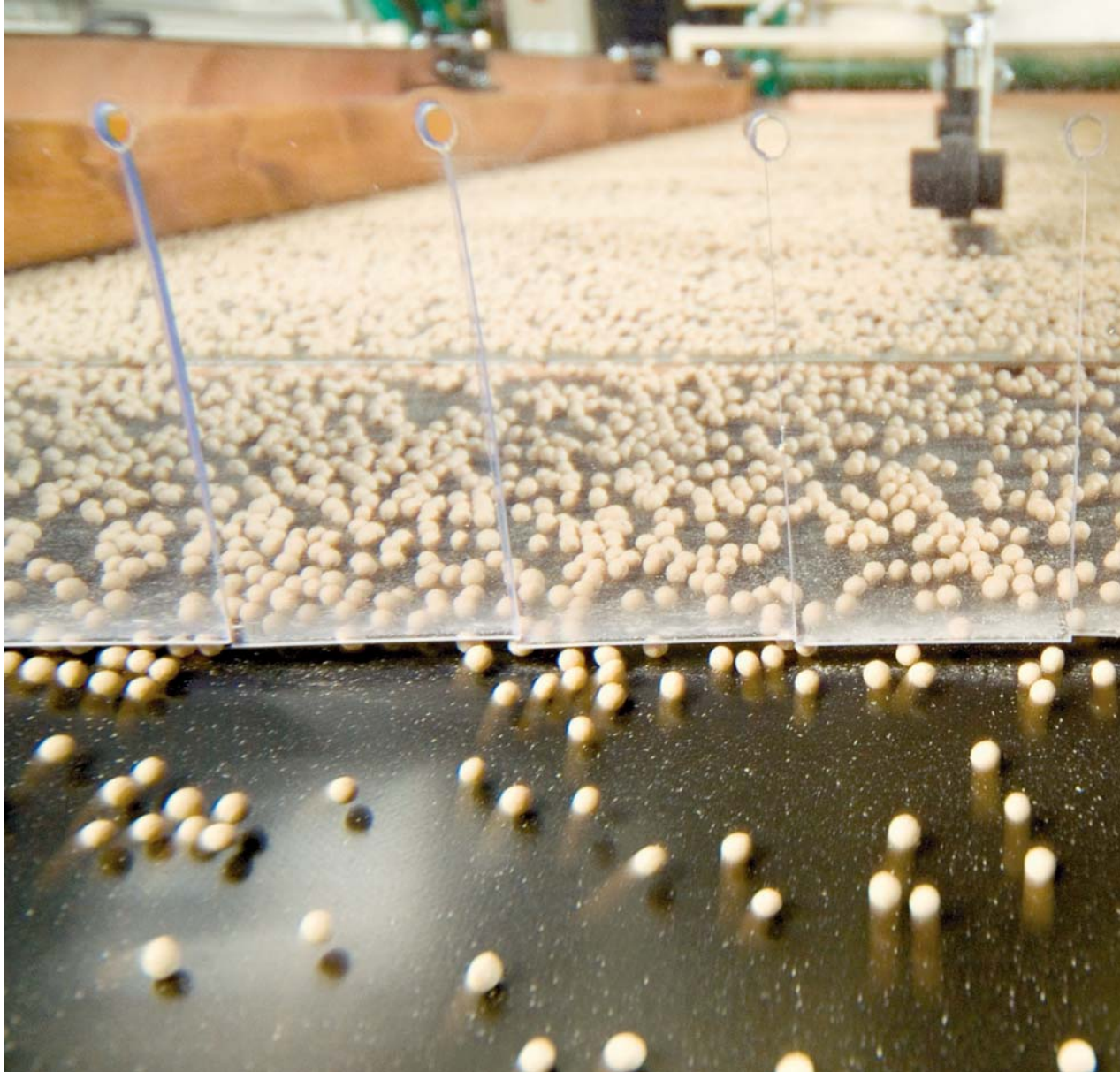
De bietenzaden worden na het pilleren gesorteerd.
