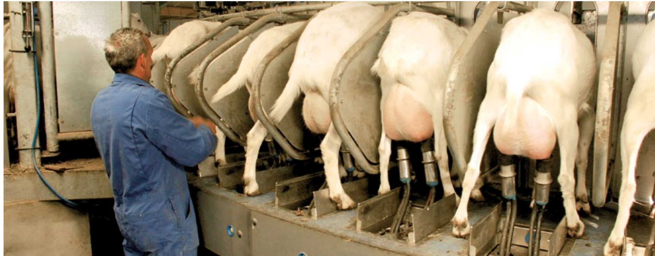
Door het automatisch opengaan van een luik komt het melkstel direct onder de uier van de geit tevoorschijn bij de nieuwe buitenmelker van Dairymaster.
