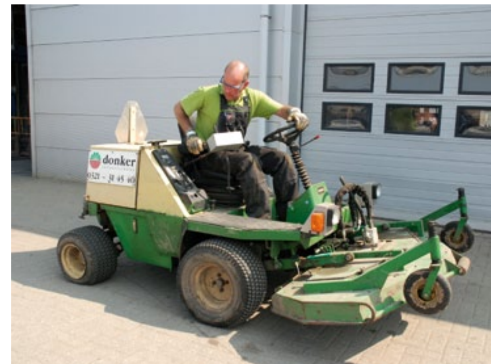
■ Een grasmaaier heeft nog weleens een lekke band. Bij een binnenband in plaats van een tubeless band is de kans op lekrijden door verschuiving van de buitenband veel kleiner.
