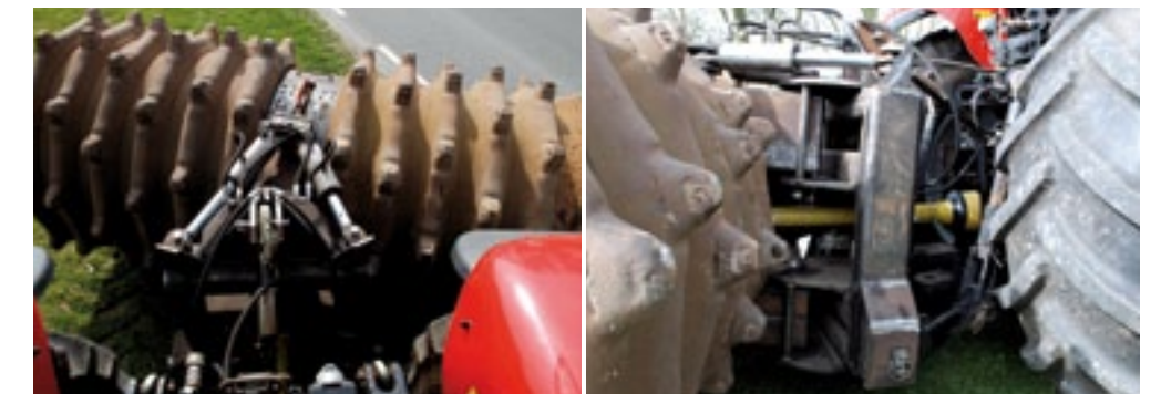
De gecombineerde compactor en verdeler van De Bruin kun je hydraulisch 25 graden schuin zetten.
