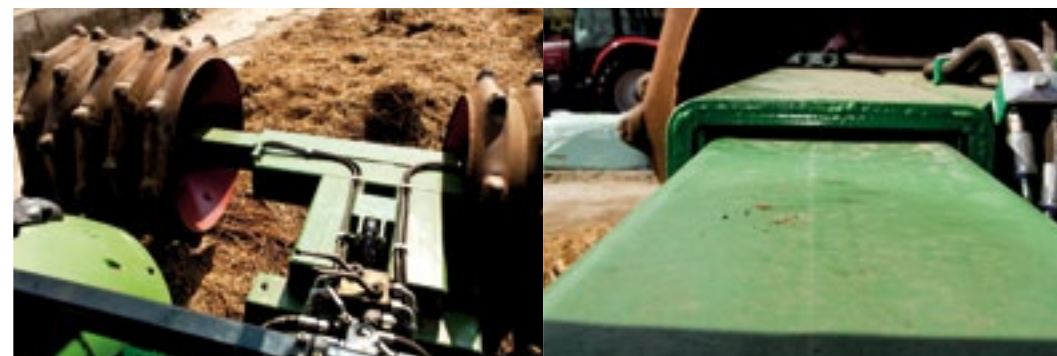
De Roeleveld-Bos compactor schuift de wielen hydraulisch naar beide kanten 80 cm uit.
