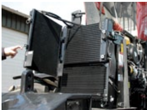
▲ Het pakket koelers is makkelijk uitklapbaar en daardoor goed te reinigen.
