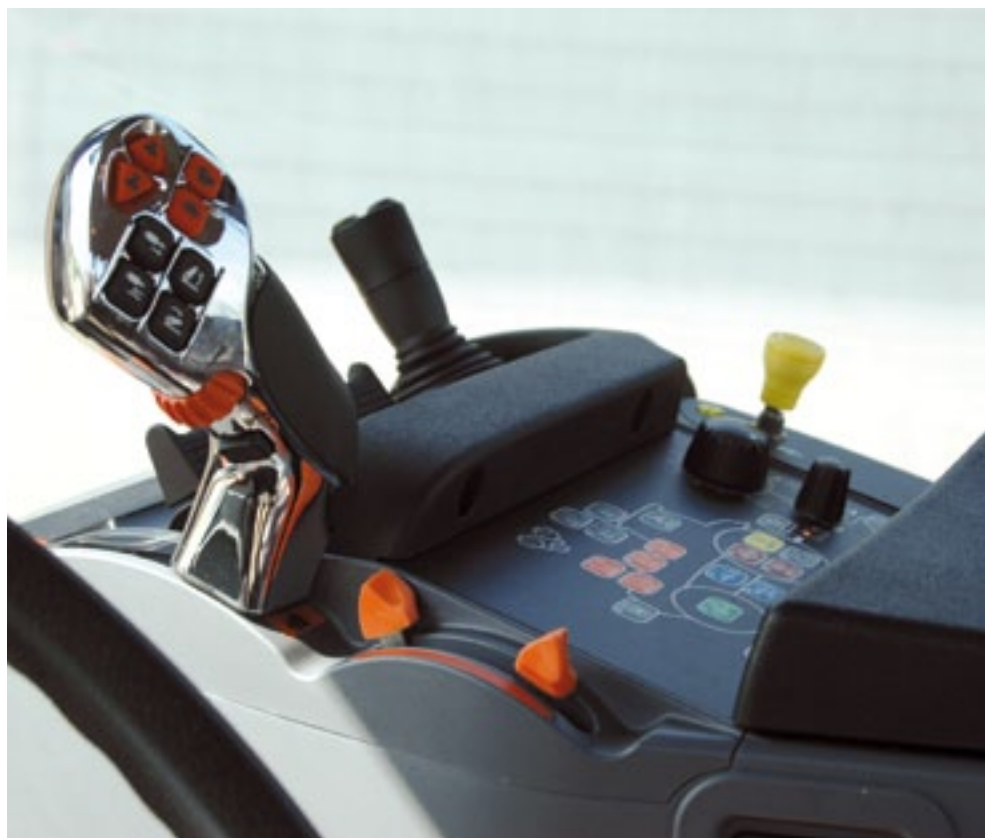
▲ Met de multifunctionele hendel bedien je onder andere cvt, hef en hydrauliek. Het wieltje dient voor de fijnafstelling van de cvt. De beide oranje hendeltjes in het midden (Eco-drive) sturen het motortoerental.
