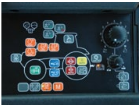
▲ Functies via tiptoetsen (ICP) zijn gekoppeld aan een tekening en vergaand zelfverklarend.
