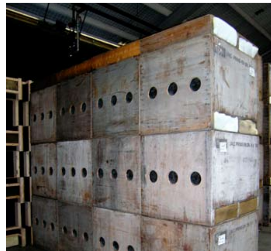
Alternatieve kuubkist (de versie met 3 buizen, metingen vonden plaats aan de versie met 2 buizen) in een half-laagssysteem
