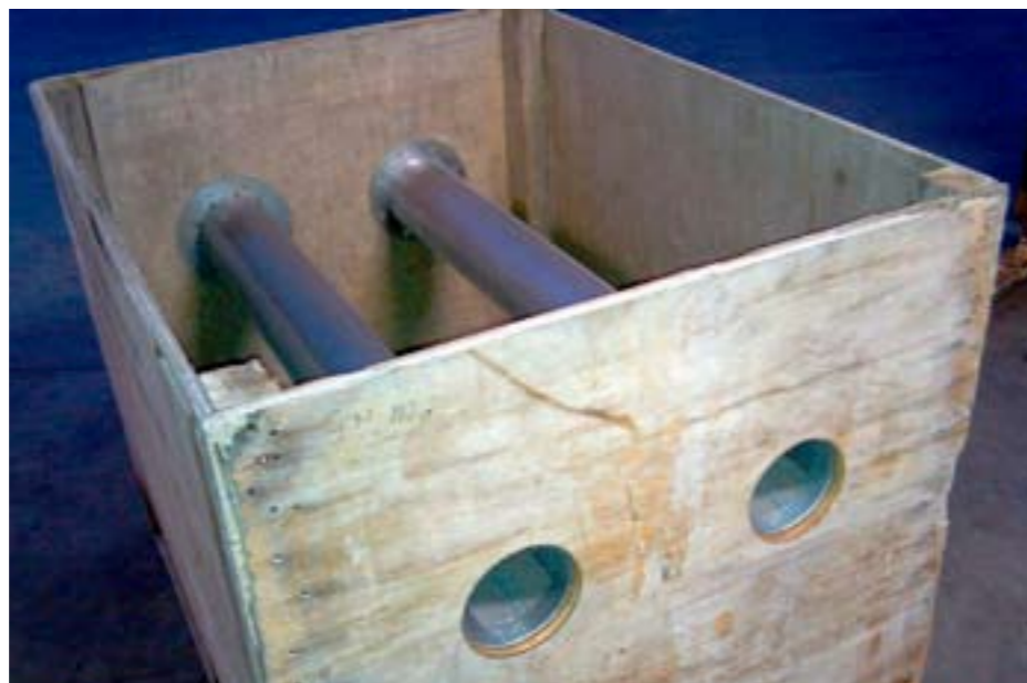
Alternatieve kuubkist met 2 buizen van voor 43% geperforeerd metaalplaat waarvan het bovenste en onderste kwadrant gesloten is
