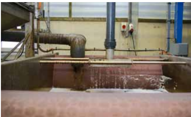
◀ De zeefdrukband scheidt de mest in een dunne en een dikke fractie.
