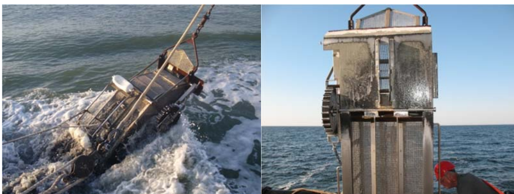
Figuur 4 Bodemschaaf. Links de bodemschaaf op het moment dat deze wordt opgehaald. Rechts de onderkant van de bodemschaaf waarop het mes is te zien. Aan de zijkant is het wiel te zien waarmee de sleepafstand wordt geregistreerd.
