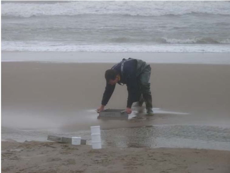
Figuur 8 Monstername strand. Te zien is hoe het rvs meetframe in de bodem wordt gedruwd
