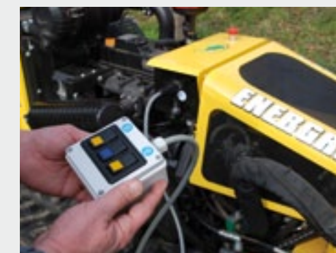
Met noodvoorziening is de Robogreen nog de aanhangwagen op te sturen.
