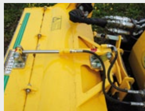
De 130 cm brede maaibak kan iets pendelen.
