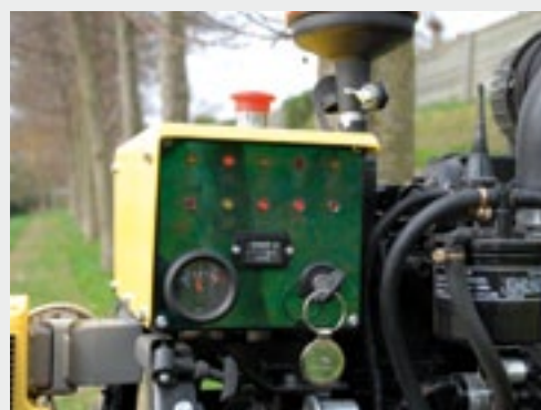
Als de sleutel op contact staat, is de hele machine met de Autec te bedienen.
