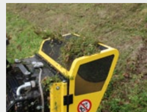
Met de omkeerbare Clean-fix ventilator is het aanzuigrooster eenvoudig schoon te blazen.
