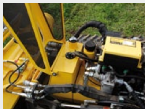
De Robogreen heeft drie aparte gesloten hydraulische circuits.
