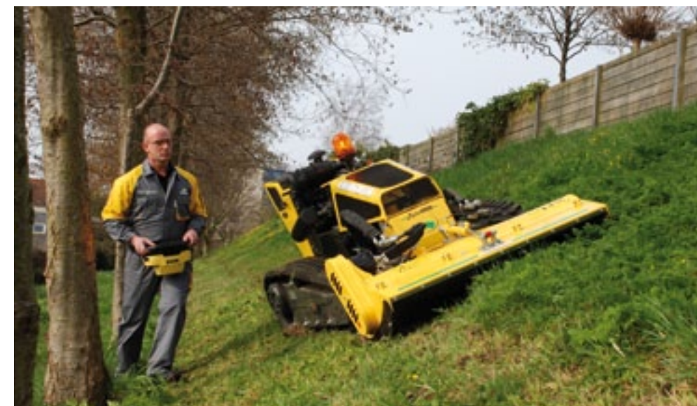
Je kunt de Robogreen tot wel 250 meter afstand bedienen. Meelopen is echter verstandig om vuil als ijzer op te merken. Dit voorkomt dat dit de klepels beschadigen.
