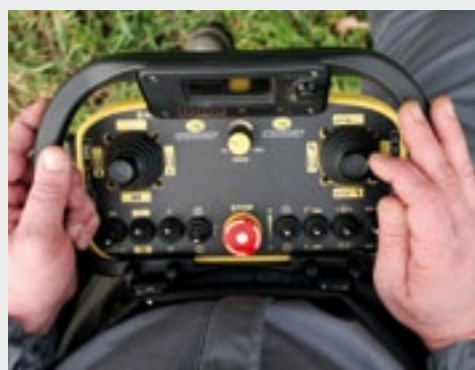
De Autec afstandsbediening: joystick links is voor-/achteruit, met de rechter stuur je.
