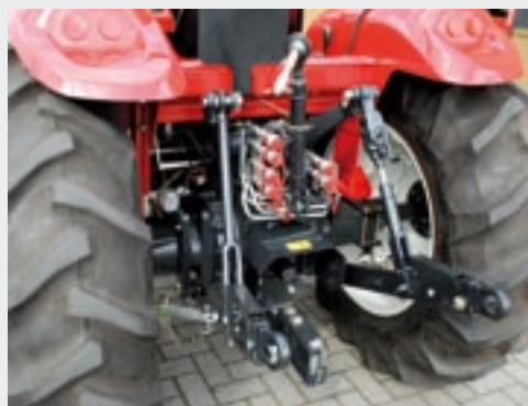
De hef tilt tussen de kogels 1.975 kg. Standaard zijn 3 DW-ventielen.
