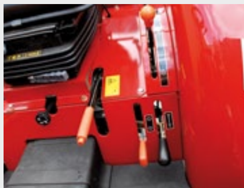
Boven de oranje groepshendel. De superkruip zit naast de zwarte 4wd-hendel.
