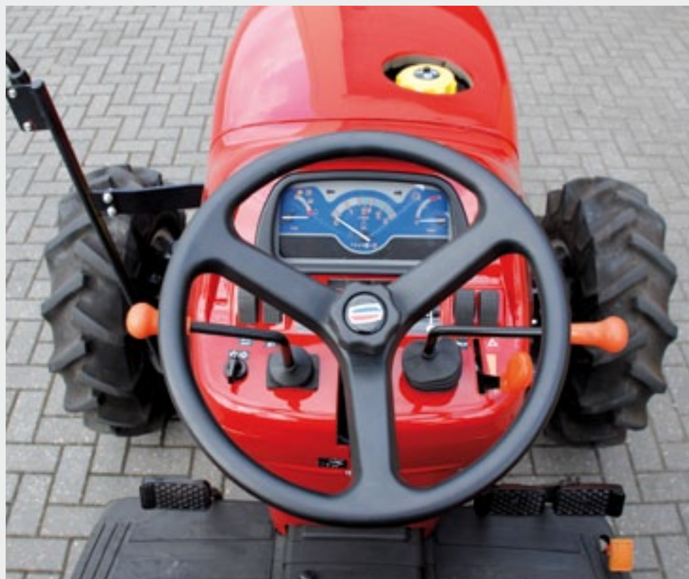
Op het dashboard zit links onder het stuur de omkeershendel. Rechts zit de grote versnellingspook, daarnaast de hendel voor handgas.
