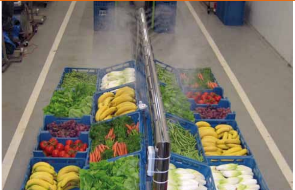
Proefopstelling voor onderzoek naar de conserverende werking van nevel.
