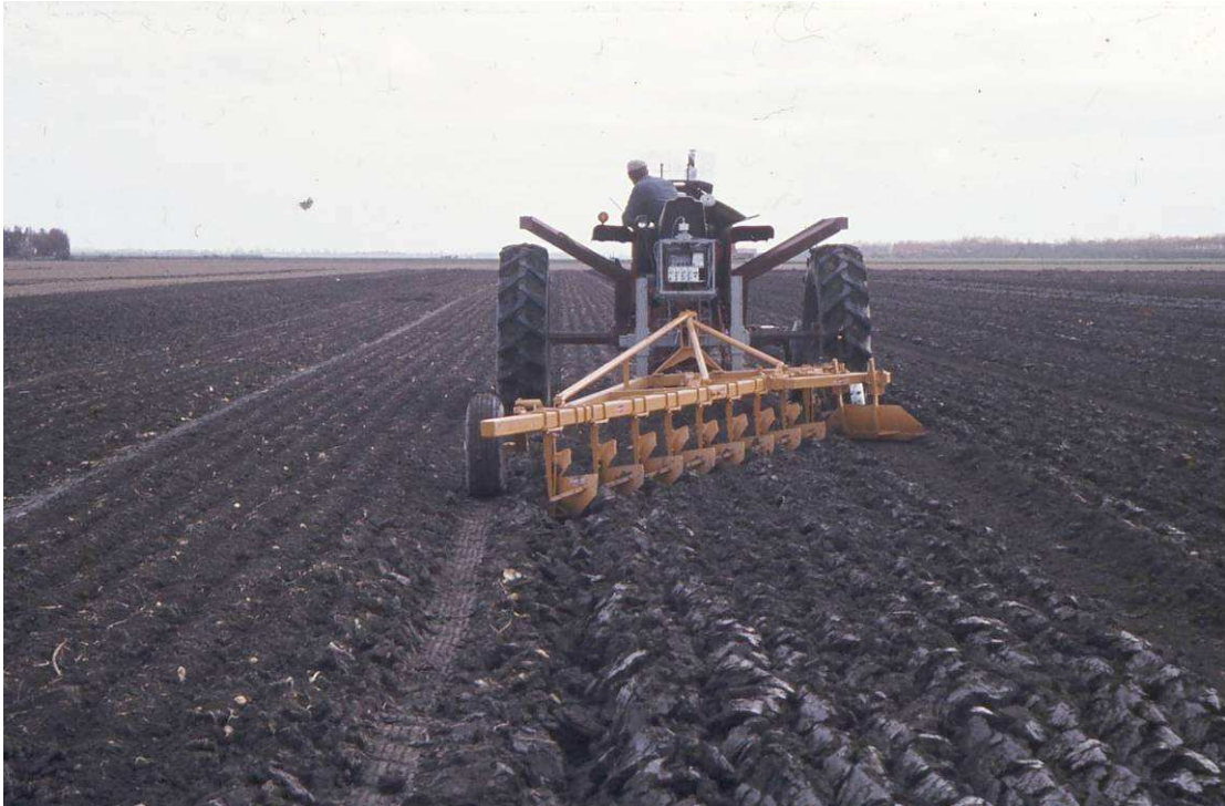
Figuur 1. Stoppelploeg voor een 3 meter rijpadensysteem met doorschuiven van de eerste snede van het bed naar de open voor in het vorige bed.
