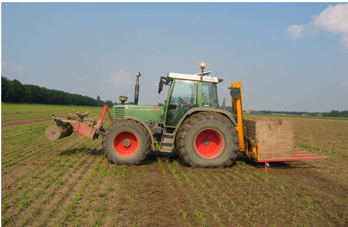
Figuur 2. Het aanrijden van de veldjes met verschillende bodemdrukken.
