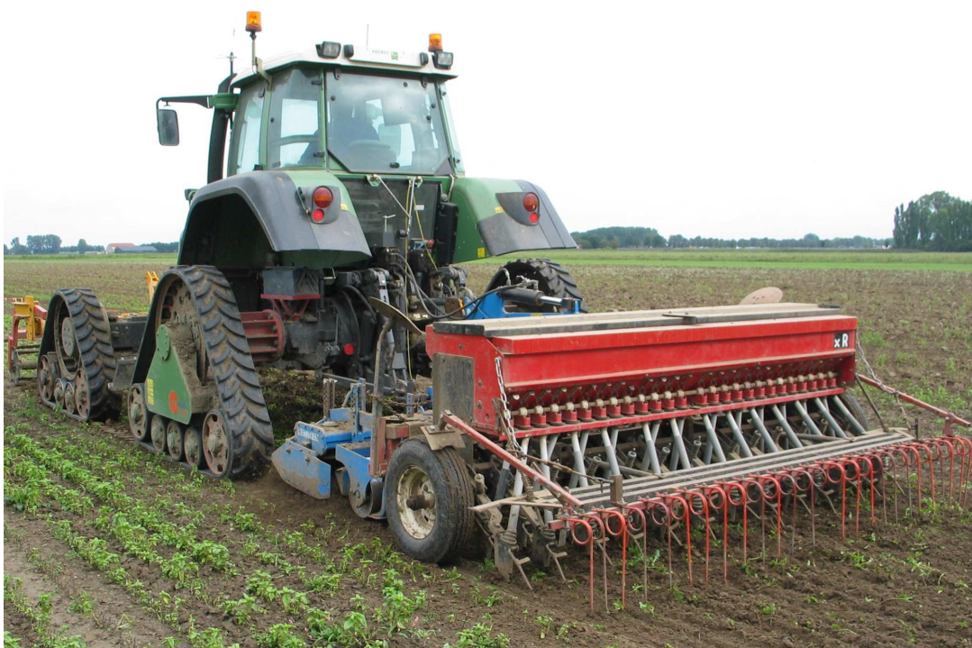
Figuur 3. Inzaai van het volggewas met de rijpaderrekker, de fronschoffel en een rotorkopeg.
