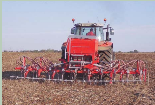
▲ De Kongskilde Vibro Seeder is een flexibel inzetbare cultivator-zaaimachine voor gebruik in ploegloze teelt. De zaaimachine is leverbaar als gedragen en getrokken model.
