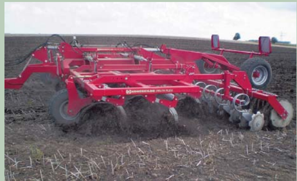
▲ De Kongskilde Delta Flex is een gedragen of getrokken stoppelcultivator voor intensieve stoppelbewerking.
