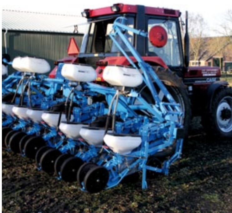
▲ De markeurs klappen op en blijven binnen de machine.
