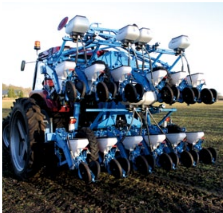
▲ De twaalfrijer in transporttoestand. De machine blijft binnen de trekker.
