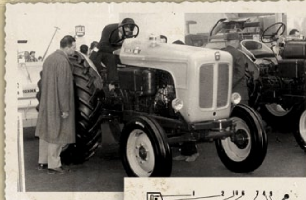
De SOM 55 (boven) heeft een 4,2-liter motor en een koppolversterker (tekening). Die levert bij tweederde van de oorspronkelijke snelheid het volle vermogen en houdt het aftakstoerental constant.
