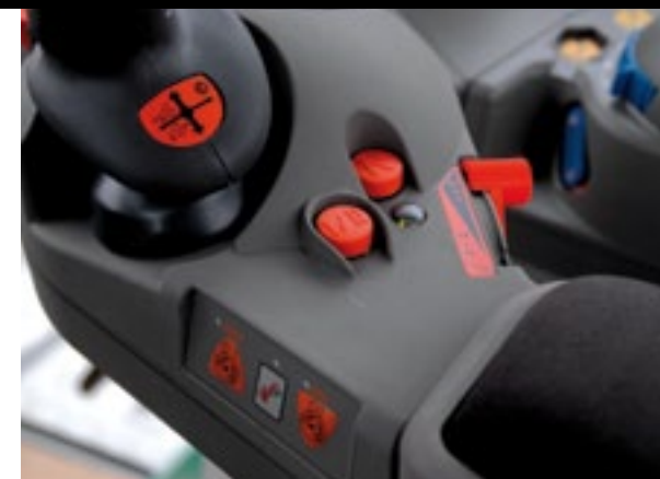
▲ Details die het werken veraangenamen: op de voorgrond het programmeerbare toerental en rechts de instelbare slag van het rijpedaal.
