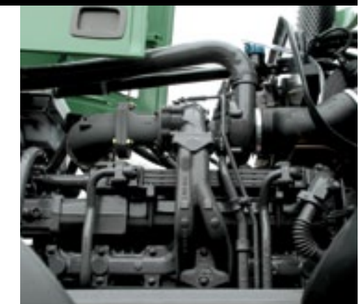
▲ De 6-cilinder vloeistofgekoelde Deutz met vier kleppen per cilinder, common-railinspuiting en intercooler staat bekend om zijn zuinigheid.
