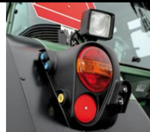
▲ De aftakas, de hef en één dubbelwerkend ventiel zijn aan de achterzijde te bedienen, zowel bij het linker- als rechterachterlicht.
