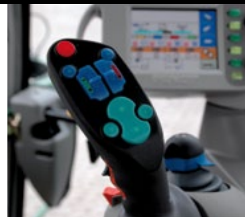
▲ De bekende joystick van de continu variabele transmissie en (op de achtergrond) de Vario-terminal dragen bij aan het succes van de 820.
