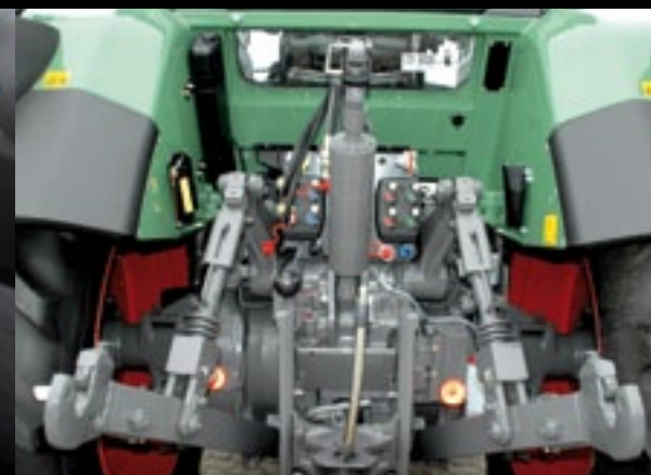
▲ Praktische techniek met standaard 9.250 kg hefkracht en drie toeren op de aftakas: 540, 540 E en 1.000. Hydraulische topstang is een optie.
