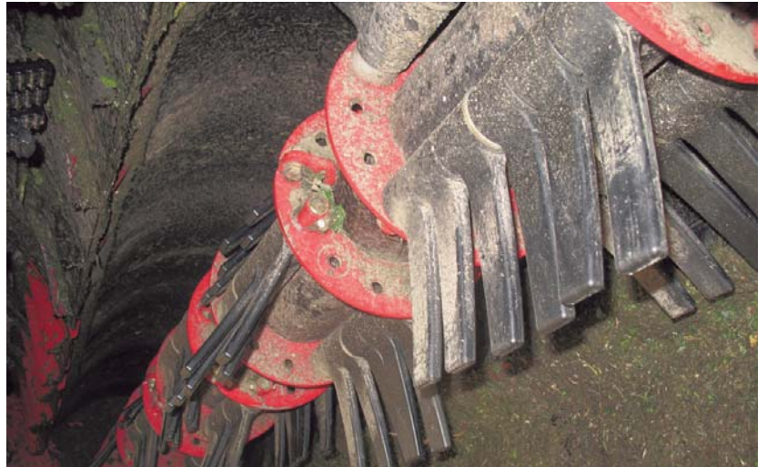
... de tweede as heeft alleen rubberen vingers die de laatste restjes blad van de biet poetsen.
