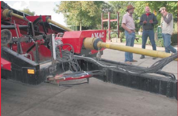
De dissel is een meter langer gemaakt om de machine te laten zwenken.
