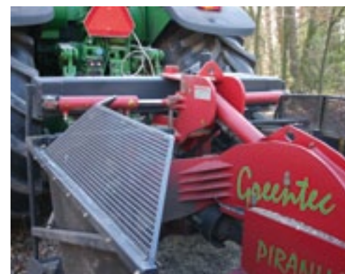
Zwenken gaat via twee cilinders. De middelste laat het freeswiel een verticale beweging maken.
