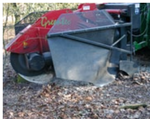
Rubberen schermen voorkomen dat snippers wegschieten. Ze draaien met de freesarm mee.
