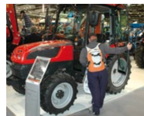
De nieuwe kleine McCormick X10 is afkomstig van het Koreaanse Daedong. De serie loopt met negen modellen van 22 tot 91 pk. De middelste versie X10-50 heeft 49 pk; dat haalt hij uit een viercilinder met 2435 cm 3 inhoud. McCormick geeft drie jaar garantie op de X10-serie.
