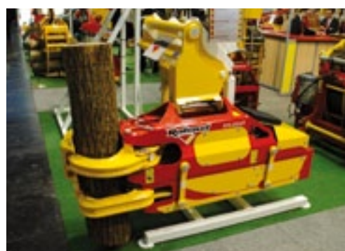
Raboud brengt nu ook een boomsnijder op de markt. Volgens de fabrikant kan deze Xylocut 300 (met 20 ton kracht op het mes) stammen aan tot een diameter van 330 mm.
