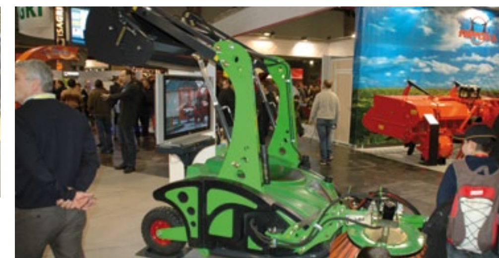
Handig om te trekken achter een transporter of een kleine tuintrekker, deze veegmachine van Cochet. De aandrijving van beide borstels (rechtsvoor en centraal) is hydraulisch; de werkbreedte is 110 cm. De 200 liter opvangbak van de City Clean kan tot 195 cm hoog lossen. ■
