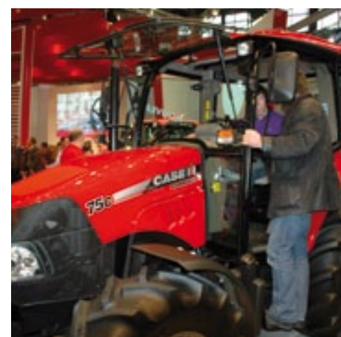
Case IH haalde in de VS de naam Farmall al eerder weer van stal en doet dat nu ook in Europa met de nieuwe 55, 65 en 75. De motorvermogens in pk komen met die type-aanduidingen overeen. Hij wordt gebouwd in Turkije en is technisch grotendeels identiek aan de T4-serie van New Holland.
