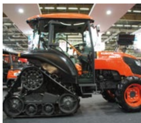
Kubota kan de achteras van zijn trekkers af-fabriek voorzien van rupsbanden. De bodemdruk (zeker met een werktuig in de hef) kan daardoor teruglopen tot minder dan de helft ten opzichte van een uitvoering op brede banden. De kans om een kwetsbare bovengrond in tact te laten en/of op een drassige grond bovenop te blijven neemt daardoor flink toe.
