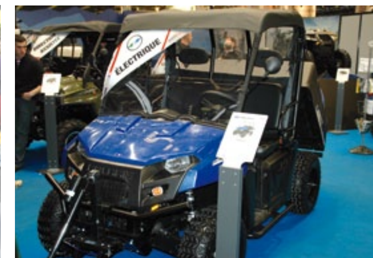
Deze nieuwe Polaris haalt zijn elektrische aandrijfkracht uit een 48 volts accupakket dat onder en achter de zitting zit, op de plek waar voorheen de motor zat. Hiermee is 80 km te rijden. In de bak kan 226 kg.
