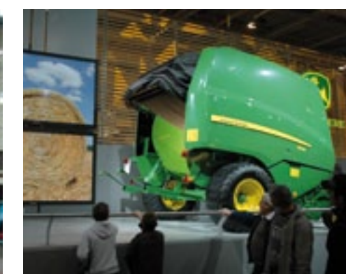
Een achterklep van doek is aanzienlijk lichter dan een versie van kunststof of metaal. Het grote voordeel van zo'n minder zware klep is volgens John Deere dat hij veel sneller open en dicht kan, waardoor de tijd die verloren gaat met het lossen van het ronde pak aanzienlijk terugloopt. De uurcapaciteit van de oprolpers neemt daardoor toe.
