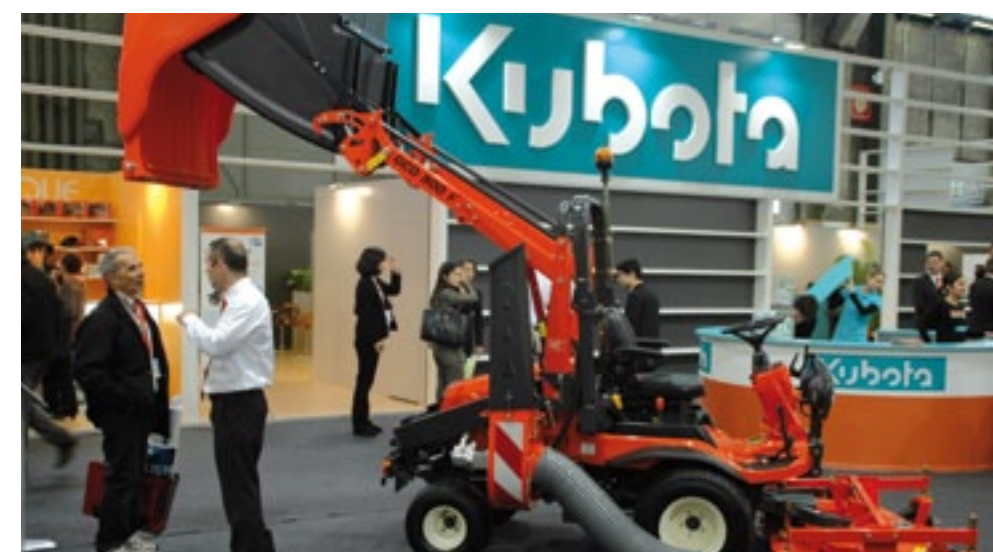
Heel hoog lossen is het sterke punt van deze nieuwe frontmaaier van Kubota die gebaseerd is op de F80. Het vermogen van de 1.500 cm 3 viercilinder dieselmotor bedraagt 36 pk. De aandrijving is hydrostatisch en de inhoud van de opvangbak maar liefst 900 liter.
