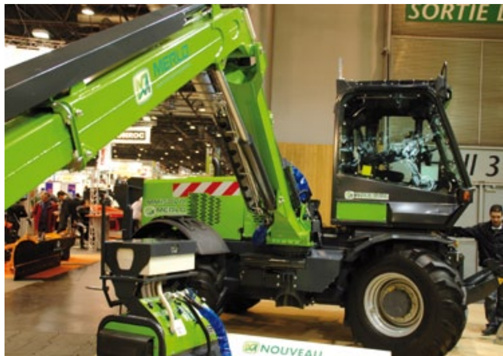
De Tre Emme MM 150 VR (hier in de kleuren van Merlo) heeft 113 kW (153 pk) aan motorvermogen. Deze werktuigendrager met driepuntshef en aftakas aan de voorzijde is met zijn draaibare chauffeursstoel en de grote ruiten ook bijzonder geschikt voor het midscheeps monteren van een hydraulische arm. Hier is dat de telescopische versie die met een klepelmaaier een reikwijdte heeft tot 10 meter uit het hart van de machine. Dat is ruim 8,5 meter naast de banden.
