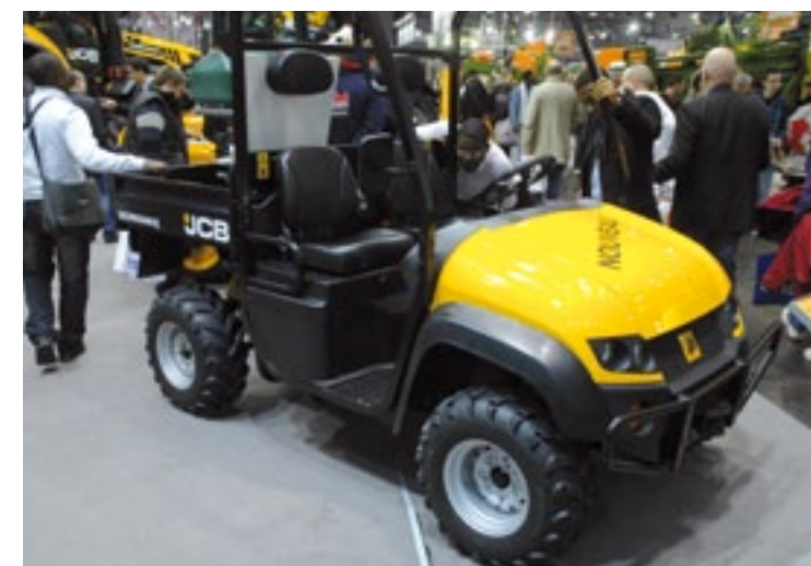
De Workmax 800 D van JCB heeft standaard vierwielaandrijving en een 784 cc Yanmar dieselmotor. Het maximale laadvermogen van deze nieuwe Britse transporter is 600 kg, in de laadbak kan 400 kg.
