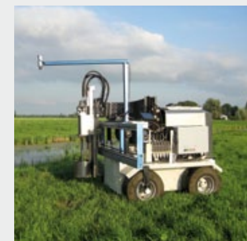
De Ruud-robot van PRI herkent zuring en steekt het uit.
