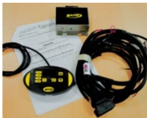
De 'zwarte doos' van Terlouw met de kabelset en de programmeerunit voor de software.
