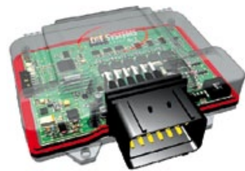
De 'black box' van DTE als opengewerkte versie: tunen is puur een elektronische kwestie.
