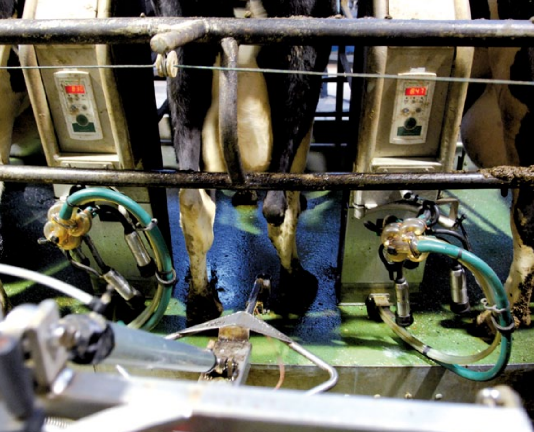
< De Ezendam Teatsprayer bestaat uit een frame dat op de vloer wordt geschroefd en een telescopische arm. Een spuitdop voorop de arm sprayt.
