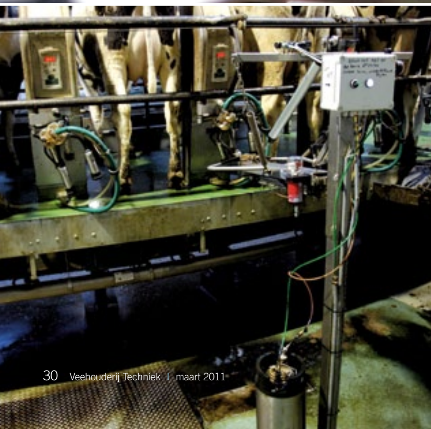
< De Ezendam Teatsprayer bestaat uit een frame dat op de vloer wordt geschroefd en een telescopische arm. Een spuitdop voorop de arm sprayt.
