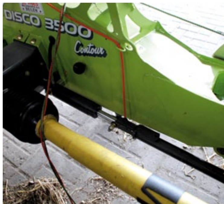
De enkelwerkende cilinder drukt tegen de arm van de maaier. De druk op de arm vermindert het gewicht van de maaier op de grond.
