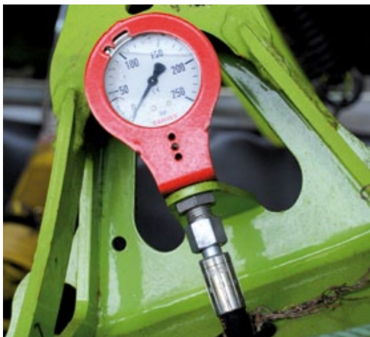
Op de drukmeter kun je zien wat de ingestelde waarde is. In de rode ring zit een inkeping voor herkenning van de standaarddruk.
