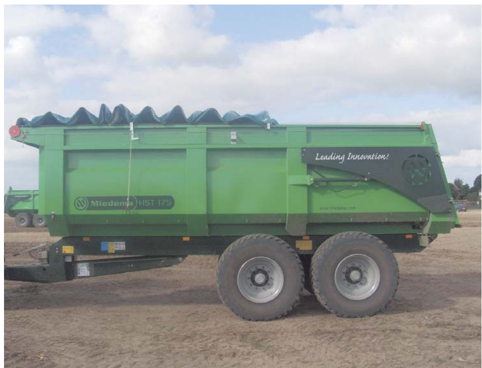
▲ Een van de afdeksystemen van het merk Cramaro werkt met een zeil dat door een reling wordt geleid en over de kieper schuift.
