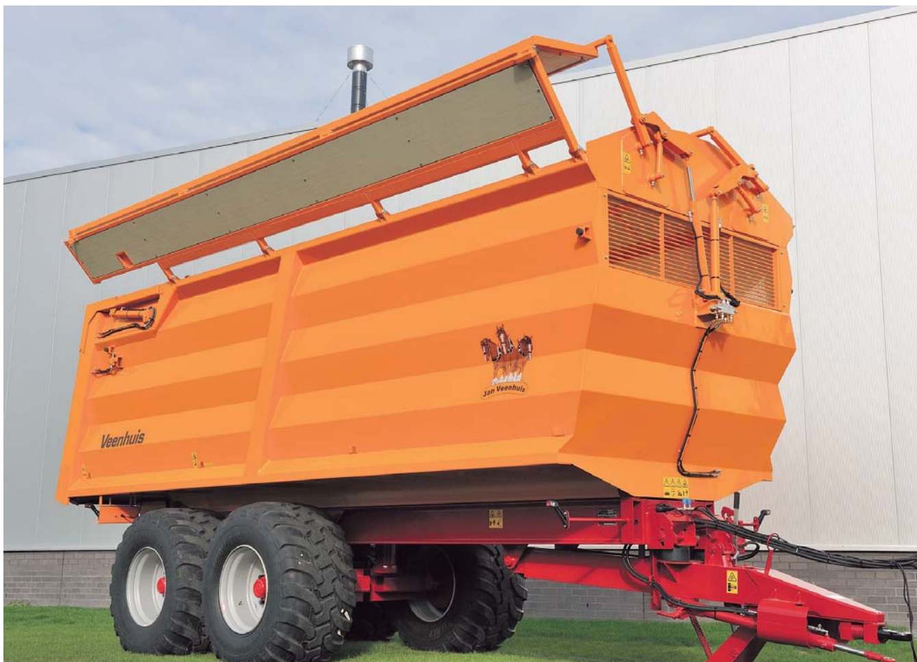
▲ Landbouwkieper fabrikant Veenhuis uit Raalte kan op zijn kiepers een afdeksysteem met hydraulisch bedienbare dakluiken leveren.
