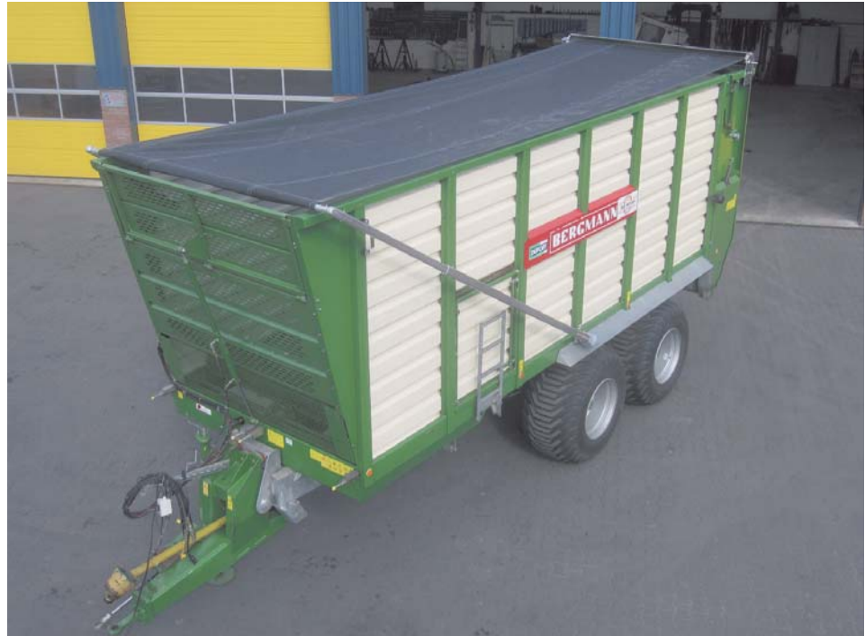
▲ Het nieuwe aluminium Quick Cover systeem dat wordt geleverd door Mechanisatiebedrijf J.W. Hoff is op bijna elke landbouw-wagen op te bouwen.
