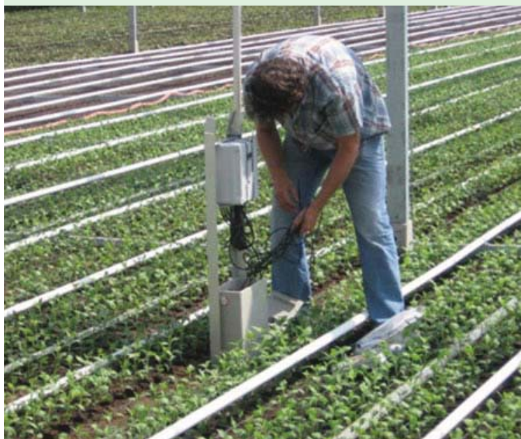
Met behulp van een lysimeter, een afgesloten ingegraven bak in de kasgrond, wordt de emissie van water en nutriënten onder uit de doorwortelde zone opgevangen en gemeten.
