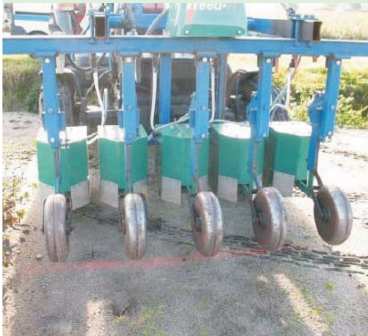
Weed-iT rijenspuit in de teelt van boomkwekerijgewassen.
