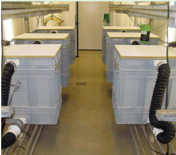
Testopstelling voor vergelijking van gedeeltelijk besmette compost met onbesmette compost (50 kg schaal).
