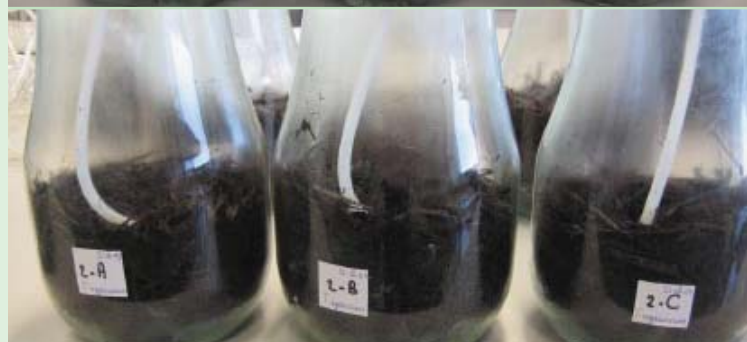
Testopstelling met besmette en onbesmette compost (300 gram schaal).
