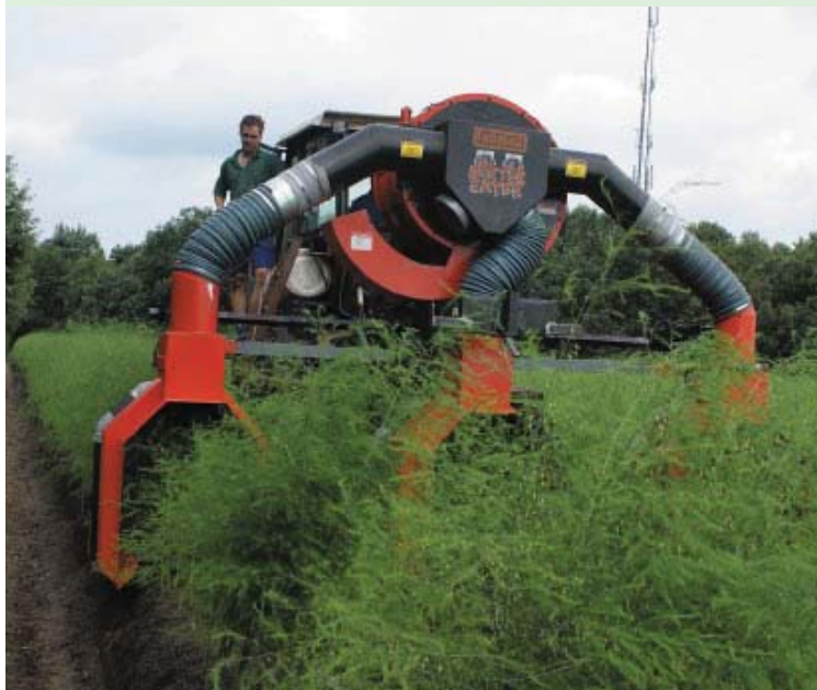
Met de beetle eater wordt 50-70 % van de aspergekevers in asperges weggevangen. Hierdoor zijn minder insecticide bespuitingen nodig en spaart men de natuurlijke vijanden.
