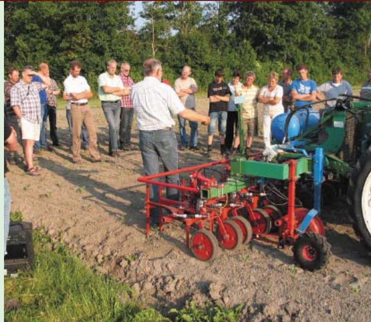
Onkruidbestrijding in kool met de door PPO-AGV aangepaste intra-rij wieder (SarL Radis) uit Frankrijk.
