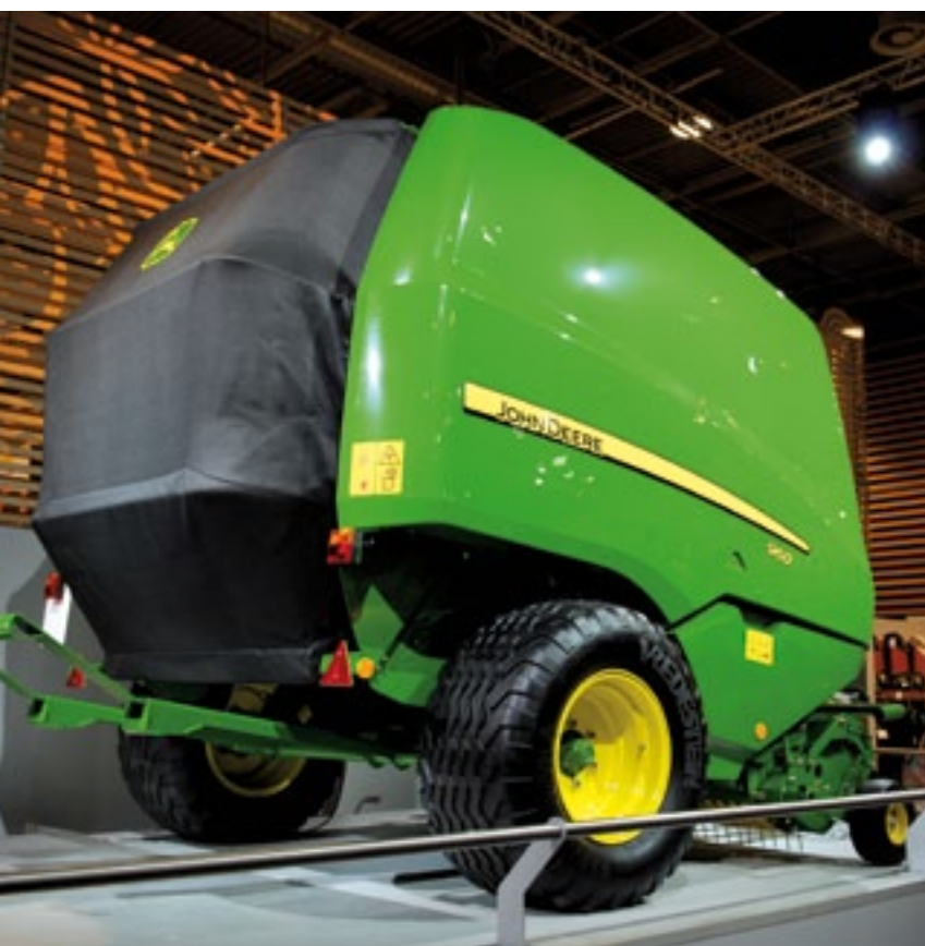
▲ De klep van de John Deere 900 oprolpers bestaat uit doek en kan door zijn geringe gewicht snel openen en sluiten. Dat komt de capaciteit ten goede.
