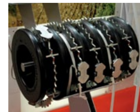
▲ De rubberen aandrukrollen van Otico zijn verkrijgbaar in een grote variatie wat betreft diameter, vorm en gewicht. Deze losse metalen ringen om de dichte schijvenvariant zorgen volgens de fabrikant bij vochtige grond niet alleen voor minder aankoecken, maar geven ook een aanmerkelijk betere (vooral vlakke) ligging van het zaai- of pootbed. Het filmpje dat Otico op de Sima vertoonde sprak boekdelen. Het (de)monteren van de TerraFlow ringen vraagt wel even tijd, want zo'n ring bestaat uit twee helften die met tweemaal vier bouten worden vastgezet. Bij een 3 meter brede rol komt dat neer op 160 bouten. Ze zitten 'los' tussen de ringen van de rol en zijn daardoor beweeglijk. LM
