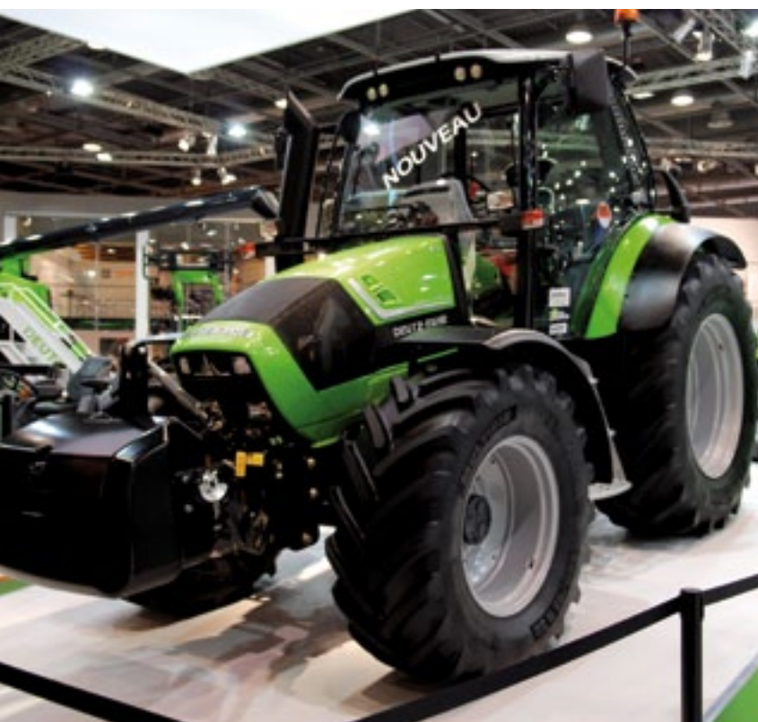
▲ De Agrotion van Deutz-Fahr is er nu ook in de lichtere vermogensklasse met de traploze transmissie van ZF onder de aanduidingen TTV 410, 420 en 430. De maximummotorvermogens zijn respectievelijk 89, 95 en 104 kW (121, 130 en 142 pk). Dat komt uit een 4,0 liter viercilinder van Deutz. Eerder kwam Deutz-Fahr al rond de 100 pk met een eigen cvt in de eenvoudige Agrofarm.
