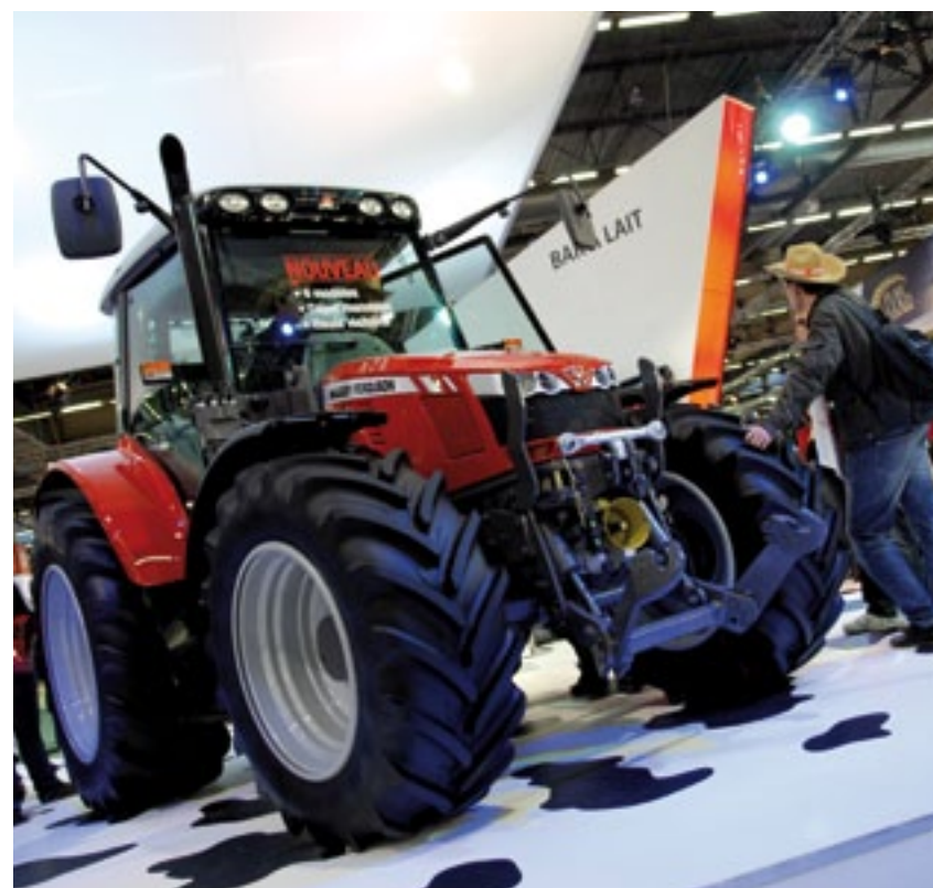
▲ De nieuwe 5400-serie van Massey Ferguson kenmerkt zich qua uiterlijk door de sterk aflopende motorkap met daarin op een fraaie manier geïntegreerd de kop- en werklampen. De nieuwkomer is er als 5420, -30, -40 en -50 met maximale motorvermogens van 61, 69, 76 en 80 kW (82, 92, 102 en 107 pk). Dat vermogen haalt de 5400 uit een viercilinder 4,4-liter Perkins.
