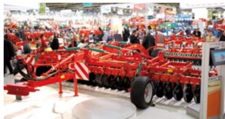
▲ Kverneland introduceert de Qualidisc compacte schijveneg, met twee rijen individueel opgehangen schijven. Die zijn per schijf gelagerd en in rubbers opgehangen. De schijven zijn niet bol, maar de buitenzijde ervan is in een hoek gezet. Dit zou ervoor zorgen dat de snijhoek van de schijven bij slijtage niet verandert. Om de afstand tussen de schijven gelijk te houden, is de laatste rij in de breedte te verstellen. De Qualidisc is leverbaar in werkbreedtes van 3 tot 7 meter.
