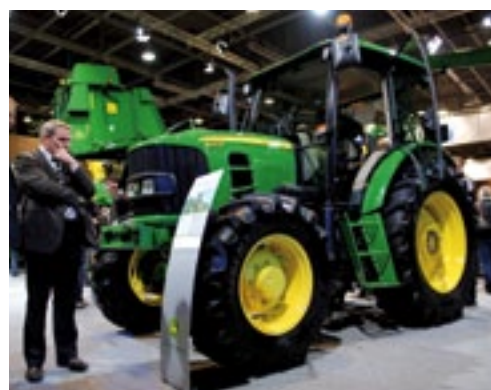
▲ Deze 'eenvoudige' en relatief lichte (zowel qua vermogen als gewicht) 6D van John Deere wordt in Mexico gebouwd. Hij moet het Amerikaans-Duitse merk een betere concurrentiepositie geven bij boeren die een lichte trekker willen voor het pure trekken, transporteren, aandrijven en tillen zonder al te veel poespas. De technische basis komt van de 6-serie, maar dan zonder het frame. De cabine is afkomstig van de 5-serie. De 6D is leverbaar met 75, 86 of 97 kW (100, 115 of 130 pk) motorvermogen. De driecilinder Powertech-M is van John Deere zelf en die springt volgens de fabrikant uitermate zuinig met brandstof om. Het dagelijkse en periodieke onderhoud van deze compacte trekker heeft volgens JD weinig om het lijf.
