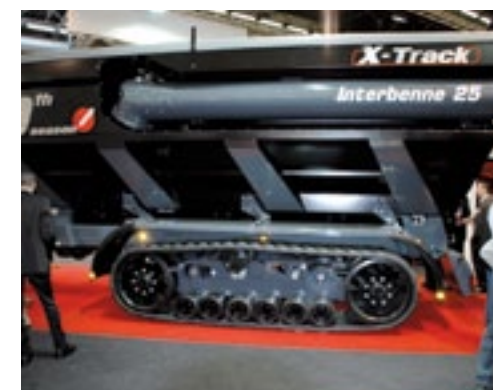
▲ Deze overslagwagen van Perard neemt de bodembescherming serieus en staat op een (niet-aangedreven) rupsonderstel met rubber van Goodyear. De Interbenne 25, zoals deze variant heet, heeft zoals de aanduiding al doet vermoeden, een inhoud van 25 kuub, maar is ook leverbaar met een inhoud van 19 of 35 kuub. Standaard heeft de 35-kuubs versie een drieassig onderstel; de twee andere zijn voorzien van twee assen. Behalve voor graan worden overslagwagens toenemend gebruikt bij het kunstmest strooien, maar ook voor het transport van beide producten. De uitstrooioveropening van de losvizel komt tot een hoogte van 430 cm.
