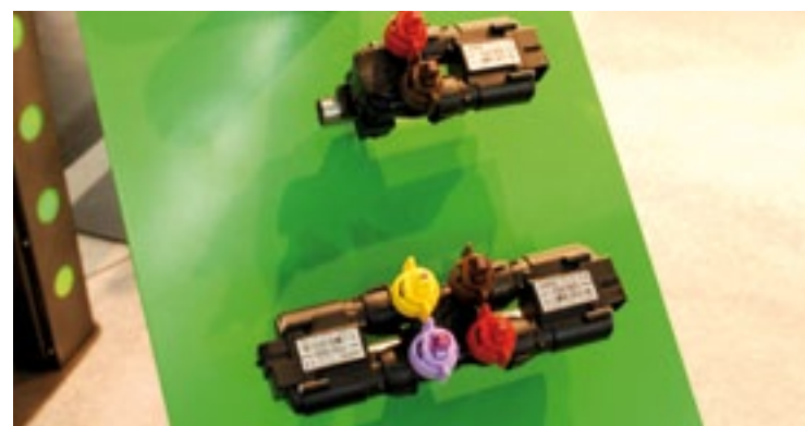
▲ Het Italiaanse Arag levert de Sele Tron elektrisch aangestuurde dophouder. De twee- of viervoudige dophouder zorgt ervoor dat je meerdere doppen tegelijkertijd of iedere dop apart kunt schakelen. Je kunt hierdoor het optimale spuitbeeld realiseren, ongeacht een hoge of lage rijnsnelheid binnen een perceel. Het tweede voordeel van de dophouders is dat je de doppen tijdens het uitgeren één voor één uit kunt schakelen.
