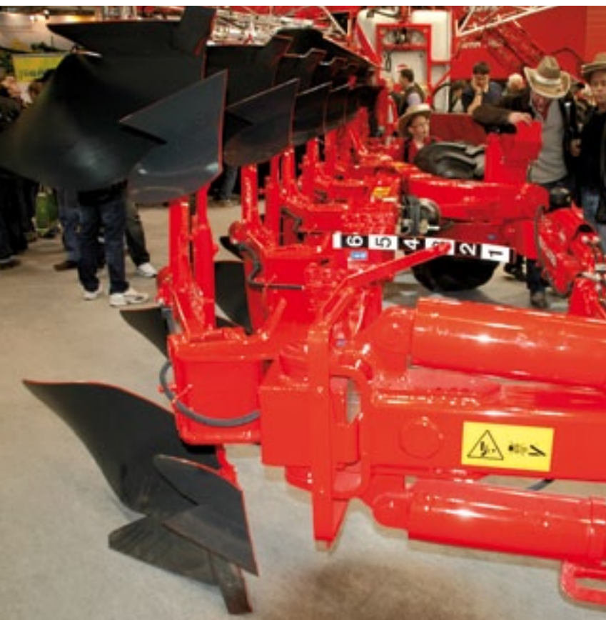
▲ Kuhns Multi-leader (6-, 7- of 8-schaar) is instelbaar op 35, 40, 45 of 50 cm breedte per schaar en traploos hydraulisch aanpasbaar aan de spoorbreedte.
