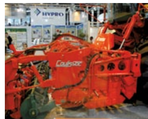
▲ De rooi-unit Coulissoc voor de Matrot Kroma beleefde zijn primeur op de Sima van 2009 en heet nu (terecht) nog steeds 'nouveau'. De Coulissoc is geschikt (te maken) voor een rijenafstand van 45 of 50 cm. De rooi-unit is de opvolger van de Vari-soc en onderscheidt zich volgens de Franse fabrikant vooral van de concurrentie door de uitstekende bodemaanpassing. Matrot noemt dat contourvolgving en claimt een beter rooiresultaat en mede daardoor minder verliezen en schonere bieten (minder tarra). De zesrijige Kroma heeft een V8-motor van Deutz met een inhoud van 15,8 liter en een vermogen van 490 pk; de bunkerinhoud is 26 kuub. De bandenmaat aan de voorzijde is 800/65R32 en aan de achterzijde 1050/50R32.
