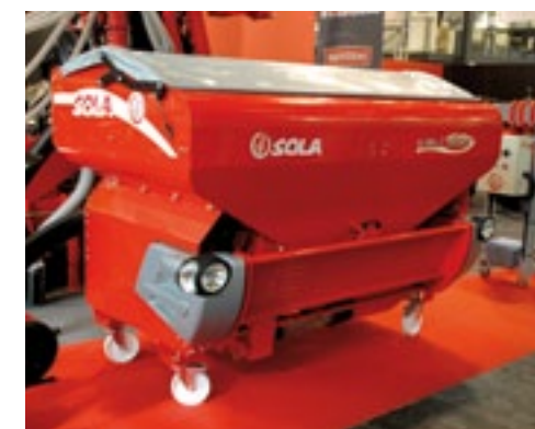
▲ Deze fronttank van Sola heet Kibli en draagt de typeaanduiding 2010. Hij is universeel inzetbaar, voorzien van goede verlichting en solide steunen om de tank makkelijk weg te kunnen zetten. Onder de steunen zijn via een splitpen snel en eenvoudig steunwielletjes te monteren, waardoor de Kibli na het gebruik makkelijk naar een hoek van de schuur te rollen is. De Kibli is bruikbaar voor zowel zaadgoed als kunstmest. Sola is de Spaanse fabrikant uit Calaf bij Barcelona die zowel mechanische, pneumatische als precisiezaaimachines bouwt en daarnaast kunstmeststrooiers. Quivogne zetelt in de plaatsen Jussey en Polaincourt en is de Franse importeur van Sola.
