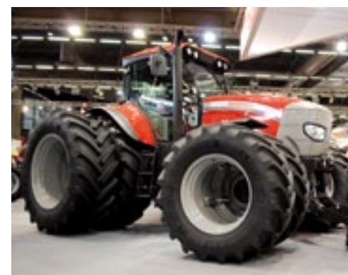
▲ De X70-80 van McCormick stond eind vorig jaar al op de Italiaanse Eima in Bologna, maar is nieuw voor de Franse markt. Deze trekker gaat het huidige topmodel TTX opvolgen. De zescilinder motor is afkomstig van Fiat Power Train en de vermogens van de trekkers uit de X70-serie uitgedrukt in maximaal vermogen zijn 131, 141, 151, 163 en 173 kW (175, 188, 203, 218 en 232 pk). Ze vervangen dus ook de GTX-serie. De trekkers hebben een 32+24 transmissie of, inclusief kruip, een 48+40, gebaseerd op een achttraps powershift die zelfstandig kan schakelen. Dat geeft McCormick aan met de naam Autoshift. De trekker gebruikt AdBlue en komt volgens moederbedrijf Argo in de tweede helft van dit jaar op de markt.
