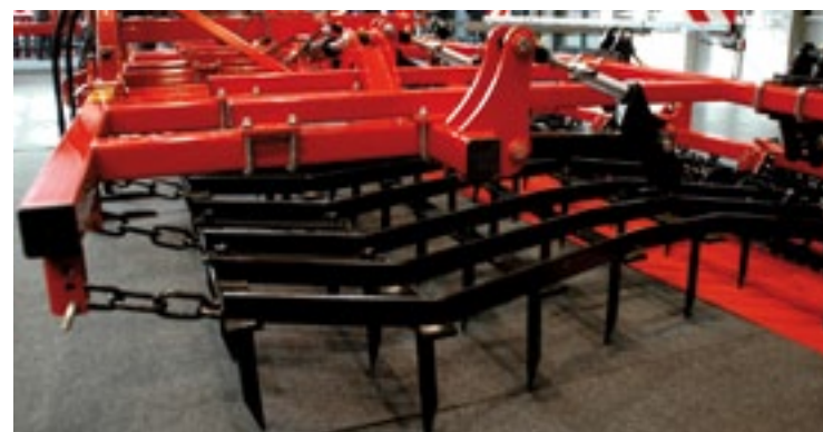
▲ Deze eg van Quivogne grijpt terug op de ketting als vertrouwd trek- en ophangprincipe. De eg kan daardoor zowel in de hoogte als in de breedte vrij bewegen. De diepte-instelling aan de voorzijde komt van de hef. Aan de achterzijde heeft elk element een eigen flexibel ophangpunt met schroefdraad. De extra zware en eveneens vertrouwde rechte tanden staan overdwars 275 mm van elkaar en in de lengte 360 mm. De werkbreedtes van deze Quivogne lopen van 530, via 630, 735 en 830 naar 930 cm.
