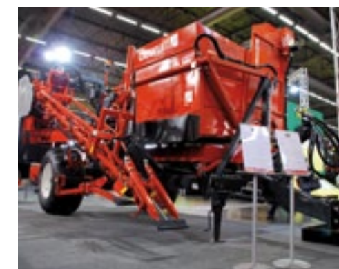
▲ De Dewulf GBC is een compacte getrokken wortelrooier met bunker. De klembandrooier rooit per omgang één rij. De C van GBC staat voor compact; dit betekent dat de rooier een iets kleinere bunker heeft en dat de machine iets korter is. De bunker is 3 ton groot en daarmee een ton kleiner dan die op de al bestaande GBI wortelrooier van Dewulf. Een parallelogram onder de bunker zorgt ervoor dat de bunker ook bij volledige belasting niet gaat hellen. De maximale loshoogte is 4 meter. De gestuurde wielen en de gestuurde dissels maken de ruim 5.500 kg wegende machine erg wendbaar. Hierdoor kan de machine ook bij korte kopakkers eenvoudiger recht voor de rij gestuurd worden.
