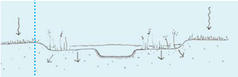
Accoladeprofiel; transport, berging en infiltratie
