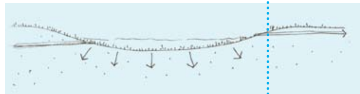
Wadi; transport, berging en infiltratie
