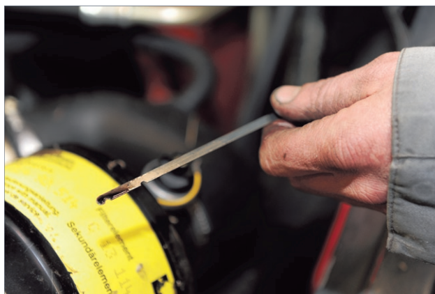
▲ Controleer het oliepeil van de motor elke werkdag, voorafgaand aan het werken met de heftruck. Voorkom dat tijdens het peilen vuil in de motor komt. Moet er worden bijgevuld? Gebruik dan dezelfde soort olie als eerder is gebruikt.
