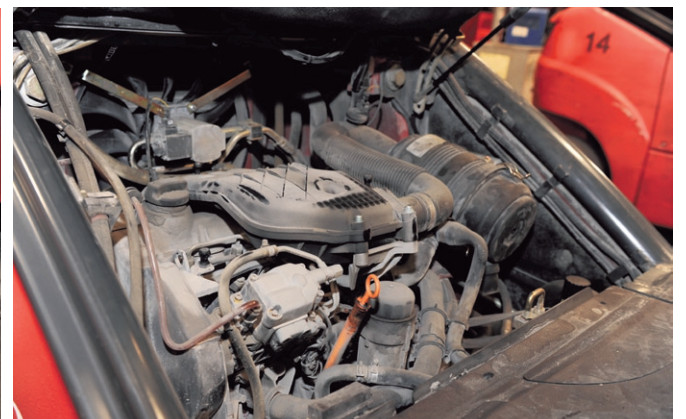
▲ Een vuile motor koelt slechter en is brandgevaarlijker. De motor kan eenvoudig met water (hogedrukreiniger) worden schoongemaakt. Spuit niet met een sterke waterstraal op elektrische componenten of op lagers.
