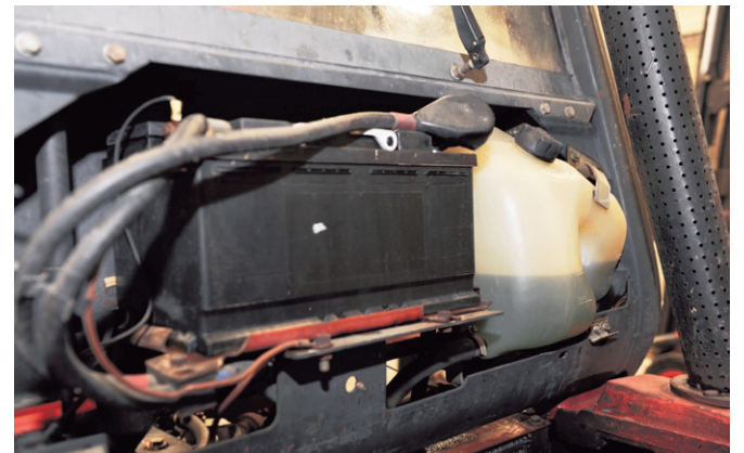
▲ Zorg ervoor dat het niveau van de koelvloeistof tussen min. en max. staat. Vul de koelvloeistof bij met hetzelfde merk en type om problemen te voorkomen.
