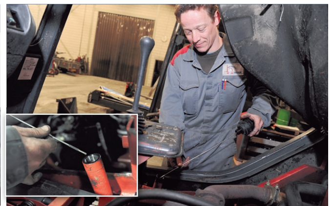
▲ Controleer elke 50 uur het peil van de hydraulische olie. Vul het systeem met hetzelfde merk en type olie als wat de dealer gebruikt om schifting van de olie te voorkomen. Zorg er heel goed voor dat er geen vuil in het systeem komt.
