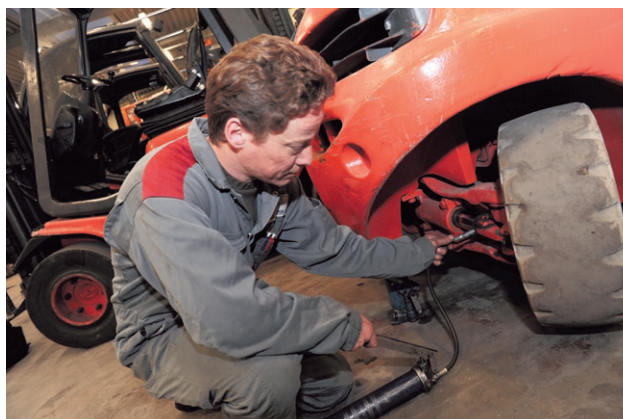
▲ Door de heftruck aan de achterzijde op te krikken komt het vet ook aan de slijtagekant van de lagers. Bedenk dat veel smeren niet helpt. Regelmatig smeren helpt wel.
