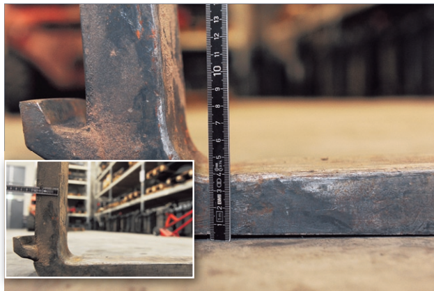
▲ Met een rolmaat of duimstok kunt u eenvoudig de slijtage van de lepels vaststellen. De hak moet minimaal 90 procent zijn van de dikte van het rechtopstaande lepeldeel. Lepels gaan langer mee wanneer ze tijdens het rijden ver genoeg worden opgetild.
