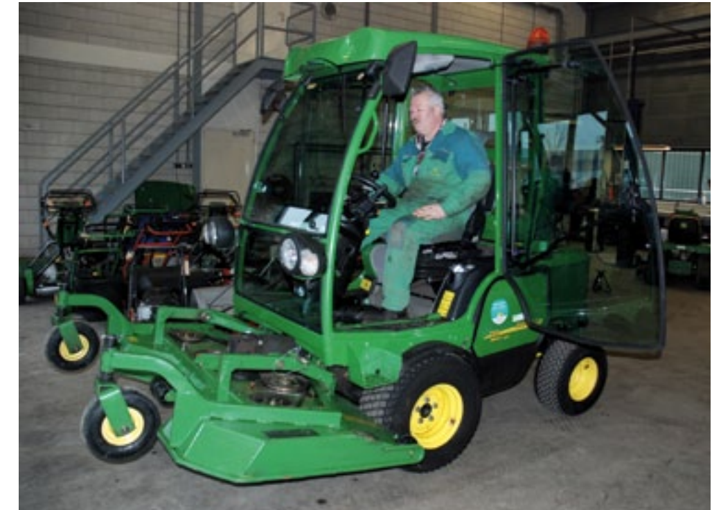
■ Het maaidek van een maaimachine heeft twee grotere loopwielen en een of twee voor kleinere scalpeerwielen. Door obstakels in het te maaien terrein kunnen die beschadigd raken.
