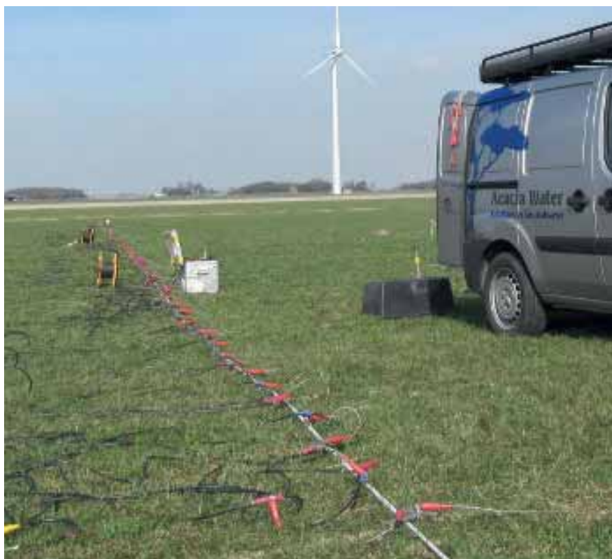
Meetopstelling van een CVES-meting, waarvan de resultaten in afbeelding 1 zijn weergegeven.
