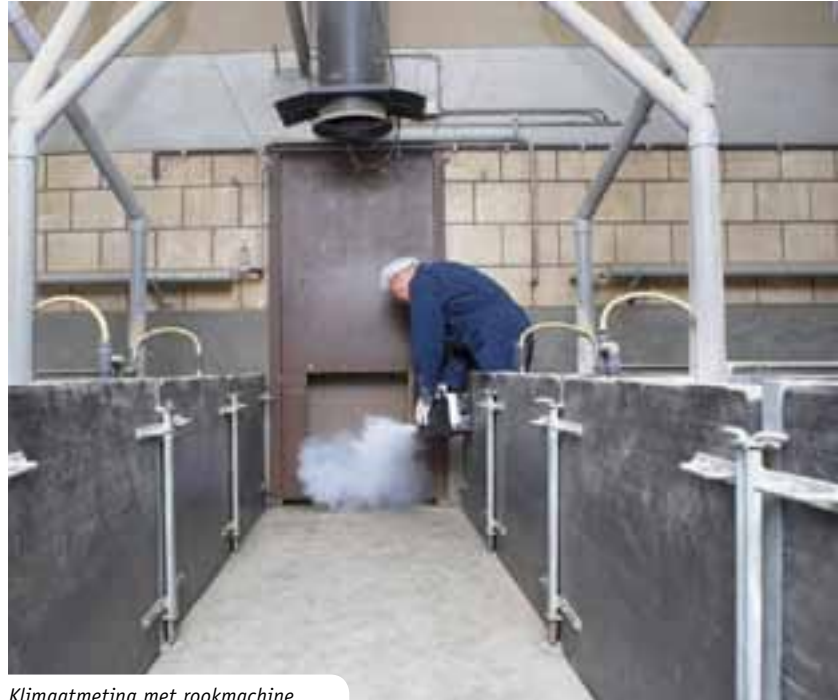
Klimaatmeting met rookmachine
