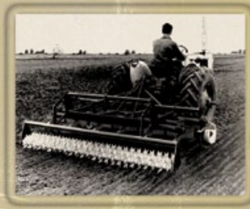
Links: De toepassing van glasvezel als omhullingsmateriaal in plaats van turf-molm is nieuw bij het draineren. Onder: De nieuwe cultivator van Lely kenmerkt zich door torsietaafvering en de bijzondere verkruiemelrol.
