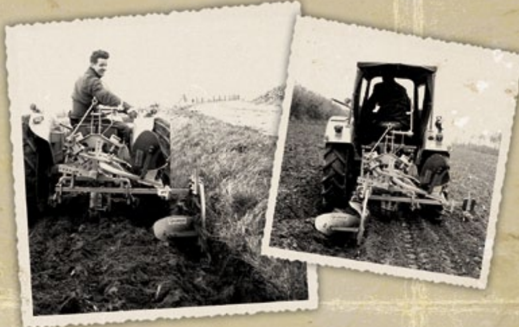
Met de nieuwe eenscharige kantelploeg van Goudland zijn ook perceelskanten goed te ploegen door verplaatsing van het rister. De werkbreedte is 30 of 35 cm.
