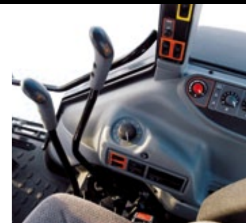
▲ Het interieur van de Valtra A93. Met twee grote poken schakel je. Rechts in de cabinstijl (in oranje) de knoppen voor de cruisecontrol.
