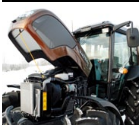
▲ De A93 is voorzien van een 3,3 liter Agco Sisu Power dieselmotor met een vermogen van 75 kW (101 pk).
