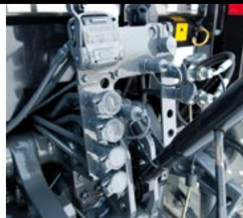
▲ De beide trekkers uit de A3-serie zijn voorzien van maximaal zes mechanisch bediende hydraulische ventielen. Twee is standaard.
