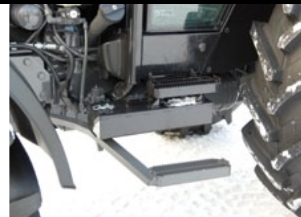
▲ Onder het trapje is een kleine gereedschapkist te vinden. Midden onder de trekker ligt de metalen 90 liter brandstoftank.
