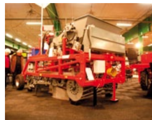
▲ Agra Exact plantmachine is een nieuw type plantmachine van Graafstra. Zowel voor als achter de plantboot is een grote kooirol geplaatst zodat de boot bodemvolgend is. Het frame om de plant-eenheid heen is aangepast, zodat de planter onafhankelijk van het frame kan bewegen. De planter is makkelijk om te bouwen van 1,50 naar 1,80 meter. Dit kan doordat beide machines hetzelfde frame hebben.
