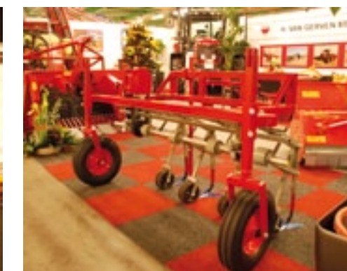
▲ Van Gerven mechanisatie levert een hydraulisch aangedreven schoffelmachine. Met de Gercon machine kan de heen en weer gaande schoffelbeweging die je normaal maakt als je handmatig schoffelt nagebootst worden. Via twee V-snaartjes drijft de hydraulische motor een as aan. De onderste as waaraan de het parallellogram gemonteerd is, heeft excentrische lagers waardoor de schoffel voor- en achterwaarts beweegt.
