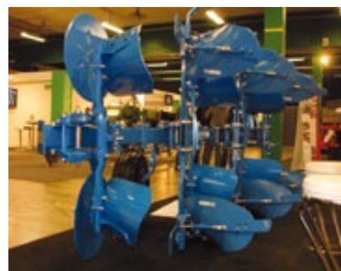
▲ Mechanisatie Haarlemmermeer past al enkele jaren ploegen van Lemken aan om op zandgronden goed ploegwerk te kunnen leveren. De voorscharen zijn hiervoor extra groot om alle organische resten onderin de ploegvoor te keren. Omdat de zandgronden altijd redelijk diep (circa 40 cm) geploegd worden, is het frame verlengd en is er aan het vierde ploeglichaam alleen een voorschaar gemonteerd. Zo rijd je met de trekker minder scheef en heeft de eerste schaar meer ruimte om te keren: 56 cm.
