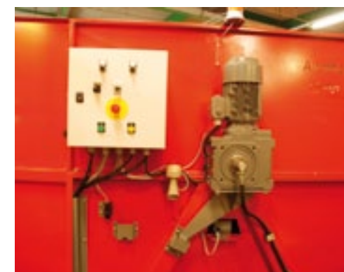
▲ De Airoator kistendraaiers van Offringa zijn vernieuwd. Optisch valt direct op dat de zijkanalen niet meer open zijn. Dit is om de veiligheid te vergroten. Technisch is de machine versneld. Al vlak voordat de bovenbak sluit, begint de machine de kist te draaien. Daarnaast biedt de fabrikant uit Creil extra veiligheidsplaten aan de voor- en achterkant. Aan de voorkant kunnen infraroodreflectoren gemonteerd worden. Zodra iemand het signaal doorbreekt, stopt de machine direct. Het programma begint pas weer na activatie op de bedieningskast.
