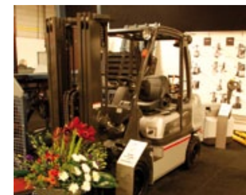
▲ Nissan hefurks presenterde een lastonafhankelijke dansonderdrukking. Hierbij zijn niet één maar meerdere accumulators aan elkaar gekoppeld. Nissan noemt dit Smooth-run. Als de hefurck over een hobbel rijdt, krijgt de lading normaal gesproken dezelfde schok. Met de accumulators worden deze schokken weggedemp. Kwetsbare goederen als glasplaten kun je met dit systeem verantwoord vervoeren.
