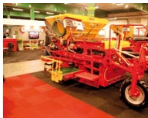
▲ Cremer Speciaalbouw werkt samen met acht bollenplantfabrikanten om de nieuwe Tel-O-Scope te integreren. Mechanisatie Haarlemmermeer toonde deze geïntegreerde Tel-O-Scope al op zijn bollenplanter. De Cremer kan tellen over de volle breedte. Hij kijkt door bloembolvellen heen (telt die dus niet mee) en laat verhoudingen zien tussen het aantal bollen dat de teller passeert. Dat wil zeggen dat hij de verhouding tussen bijvoorbeeld de zijkant en het midden kan later zien. Alle met een breedte van 15 cm. De Cremer telcomputer is naast de MultiTronic bedieningsterminal van de planter gemonteerd. Aanpassen van de dosering gaat dan ook volledig automatisch.
