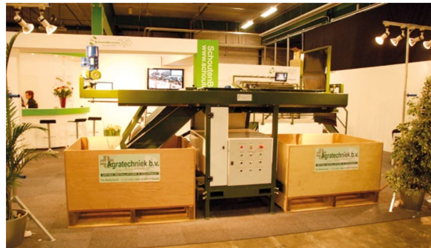
▲ Nu Schouten en Bercomex samen zijn gegaan, is de kistenvuller vernieuwd. De kistenvuller van het type KKB is nu grotendeels in eigen huis gebouwd. Grootste verandering is dat de banden nu elektrisch via een spanband bediend worden. Er zitten dus geen hydraulische componenten meer op de KKB. De machine is verkrijgbaar vanaf 17.000 euro.
