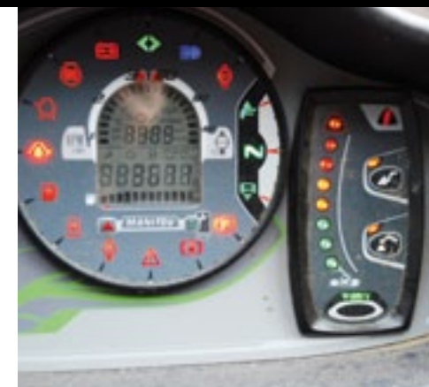
▲ Het digitale dashboard geeft alle benodigde informatie weer. De lastmoment-indicator laat de belasting van de machine zien.
