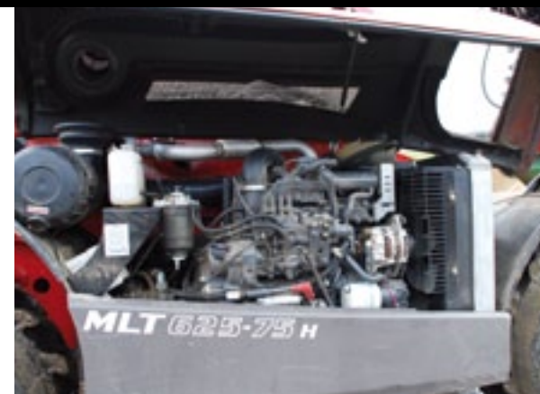
▲ De dagelijkse onderhoudspunten van de Kubota motor zijn goed bereikbaar aan de rechterzijde van de machine.
