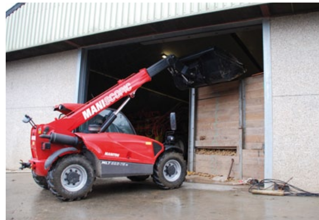
▲ De MLT 625 is geschikt voor diverse klussen op het akkerbouwbedrijf. Door de hydrostatische transmissie is hij echter niet geschikt voor het trekken van zware lasten.
