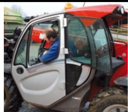
▲ De ruime cabine geeft goed zicht rondom. De condensor van de airco zit onder de 'klep' achterop de cabine.
