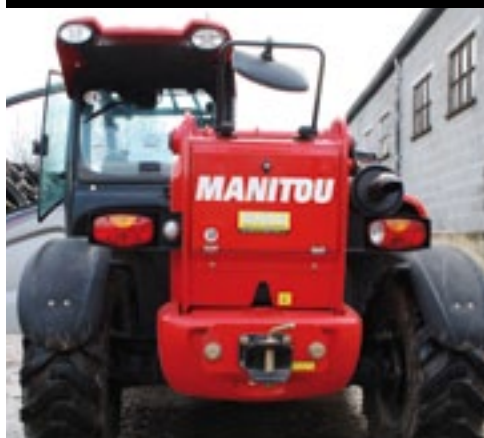
▲ De vulopening van de brandstoftank is achter het afsluitbare luik aan de achterzijde geplaatst.
