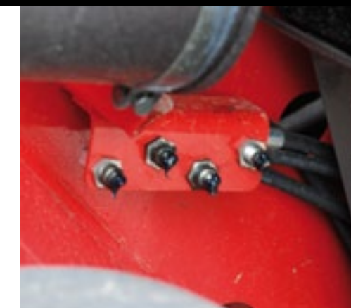
▲ Manitou brengt de smeernippels van de boom bij elkaar ter hoogte van het rechterachterwiel.
