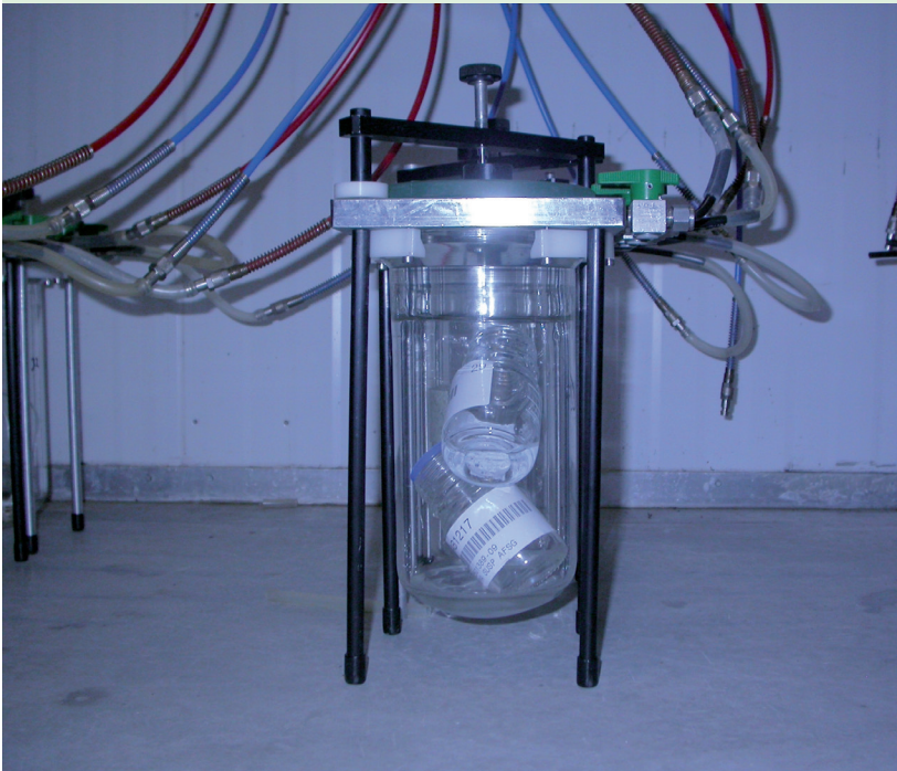
Toetsing afdoding nematoden in suspensie met bekende concentratie (Food & Biobased Research, april 2010).
