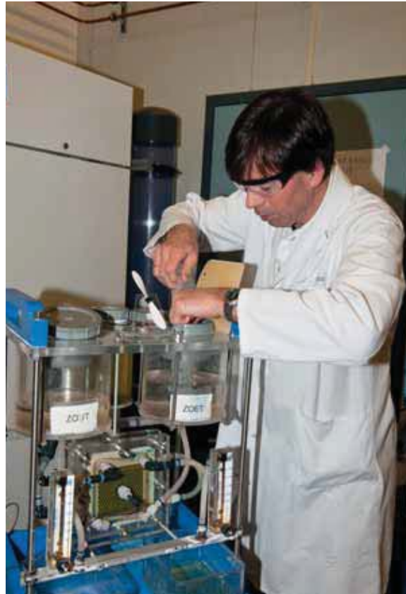
Michel Saakes laat een propellor draaien door zout en zoet water te mengen.
