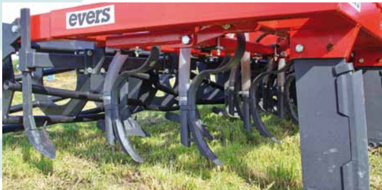
Drijfmestinjecteur met GPS-registratie, zodat de mais daarna bij de mest gezaaid wordt.
