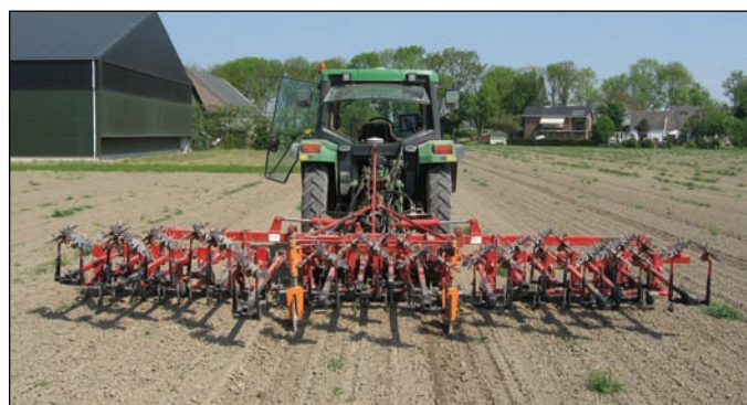
RTK-GPS met zowel trekker als machine besturing
