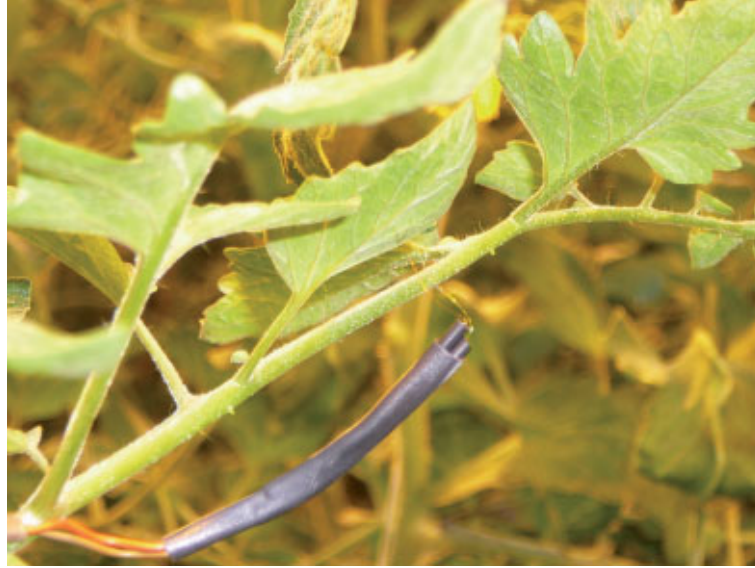
Bladtemperatuur meting met een thermokoppel.
