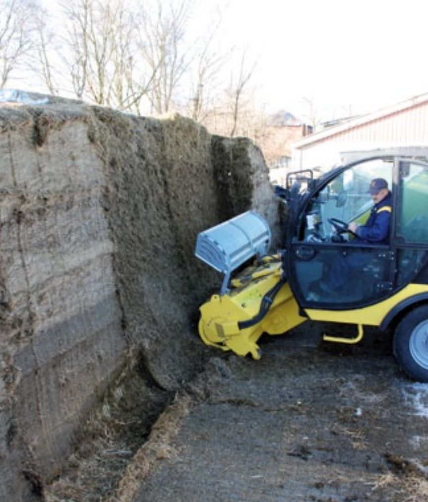
De freestrommel met snijmessen vraagt minder vermogen tijdens het laden van graskuil.
