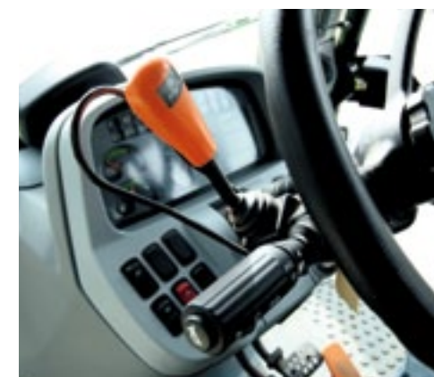
De hendel voor voor- of achteruit bedient soepel en wegrijden is mogelijk zonder gebruik van de koppeling. Het stuur is ruim verstelbaar.
