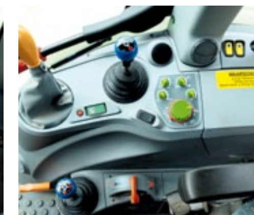
Linksboven de pook voor de vier versnellingen. Linksonder de hendel van de kruipbak en midden onder het handgas met 'memory-knop'.
