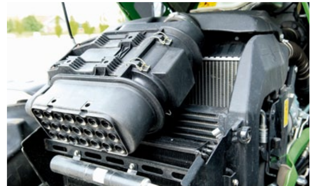
De koelers en het luchtfilter zijn bij een geopende motorkap goed bereikbaar voor reiniging.
