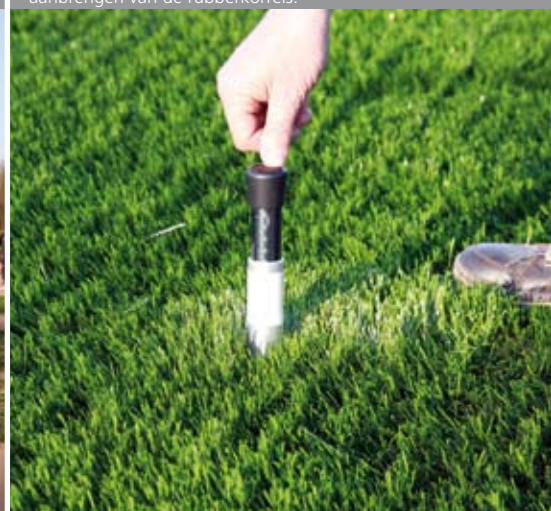
Meting van de dikte van de zandlaag. Dit moet 10 millimeter zijn. Er komt ook een keurmeester om dit na te meten, pas daarna mag men beginnen met het aanbrengen van de rubberkorrels.
