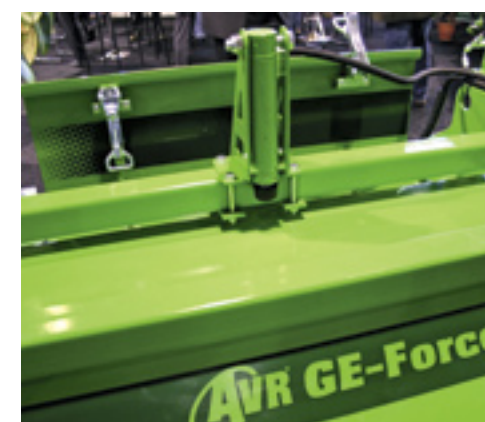
Een cilinder drukt de verende AVR kap naar beneden, waardoor freeshaken de kap maken.
