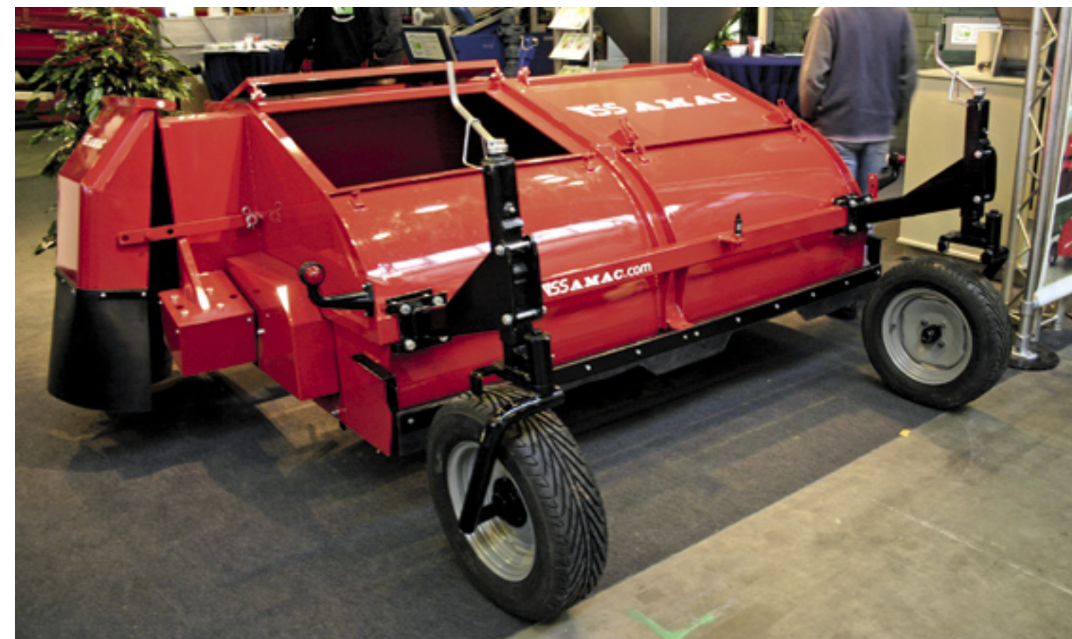
De vernieuwde LK2Z van VSS Amac. De ruime kap geeft de ruimte voor de lange klepels. Dit zorgt voor een betere zuigwerking en loofafvoer.
