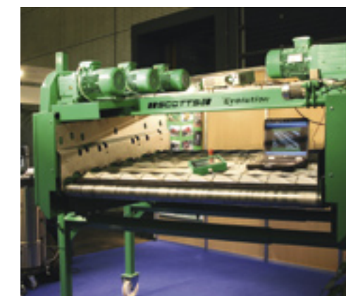
De Evolution Separator heeft luchtkamers in de rollen voor harde kluiten en stenen.
