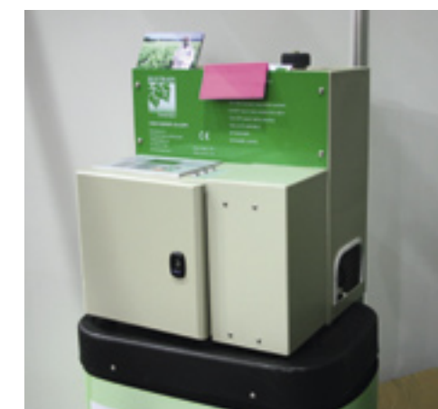
De Restrain Generator zet ethanol om in ethyleen en zorgt voor een kiemrustige bewaring.
