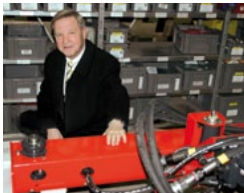
▲ De elektrische aandrijving van de EDR haalt een efficiëntie van 75%. Hydraulisch is dat rendement 25%, terwijl de regelbaarheid van de elektrische versie aanmerkelijk beter is.
