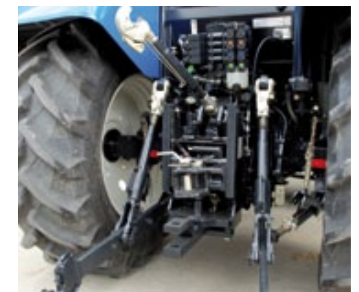
▲ De hef heeft 'dikke' cilinders en tilt volgens New Holland ruim 7 ton. Wij maten ruim 6 ton.
